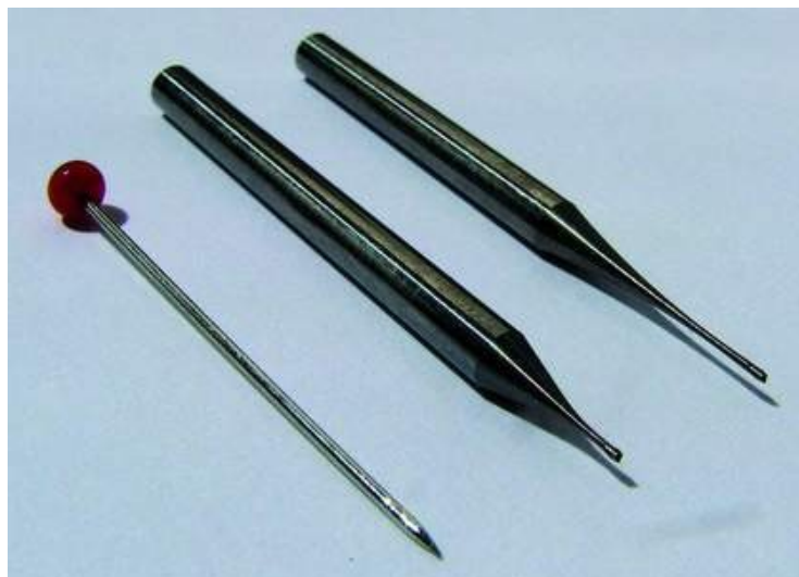
Abbildung 3.3: Mikroschaftfräser mit optimierter Geometrie im Größenvergleich [25]
