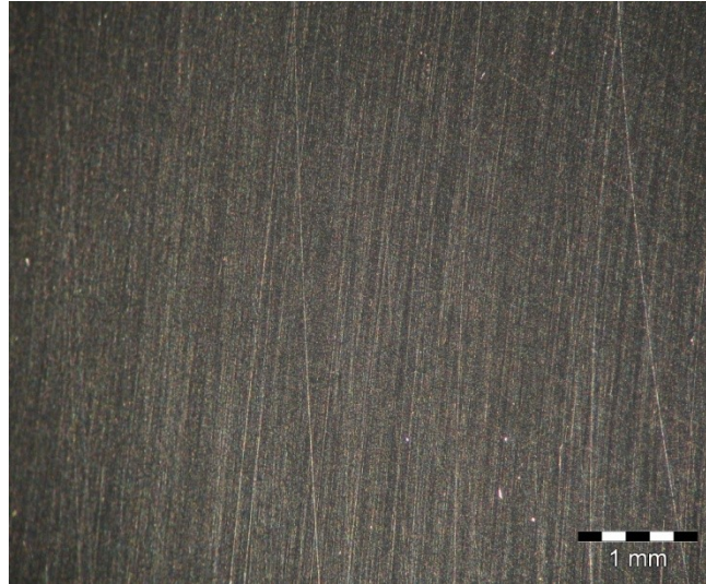
Abbildung 10.12: Handgeschliffene Probe mit Stereomikroskopie
