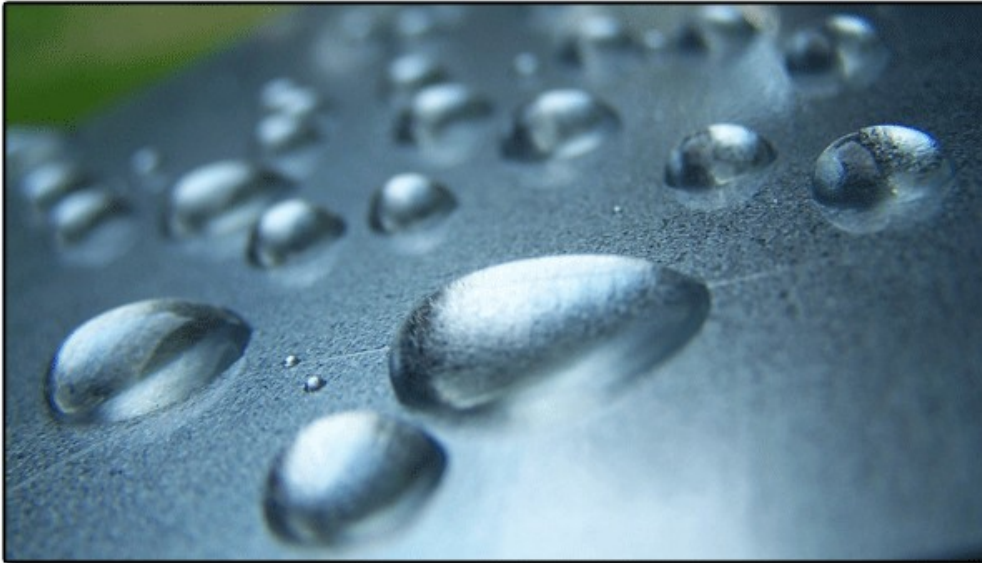
Abbildung 4.8: Easy-to-Clean eines verzinkten Stahlblechs [46]
