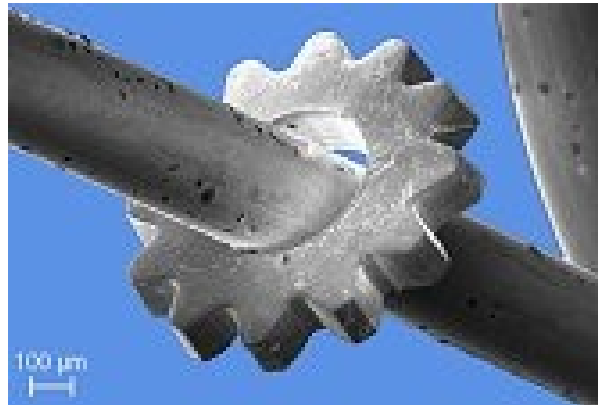
Abbildung 7.9: Mikrozahnrad mit µMIM [85]
