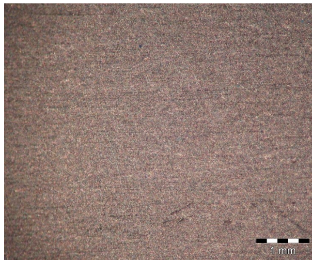
Abbildung 10.1: Elektropoliertes Blech mit Stereomikroskopie
