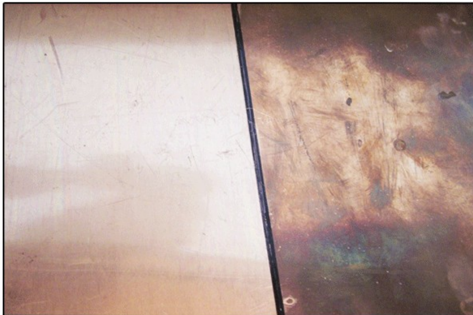
Abbildung 4.9: Sol-Gel-Korrosionsschutz anhand eines Kupferblechs [45]
