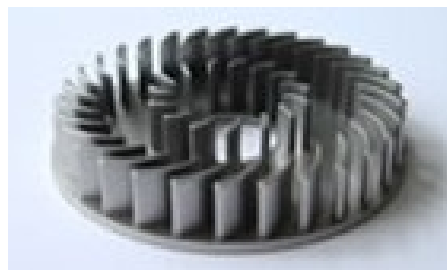
Abbildung 2.7: Turbinenschaufel mit PEM-Verfahren [80]
