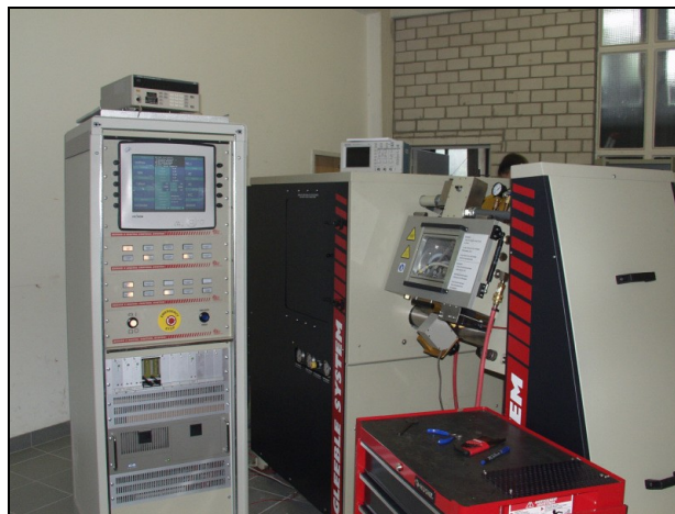
Abb. 3.5: Übersichtsaufnahme einer Gleeble 3500 [13]
