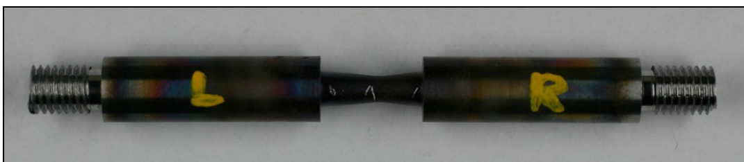
Abb. 5.3: Umgeformte Zugprobe des Vorversuchs 10
