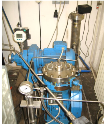
b) Gasverdichter, digitales Manometer für Vordruck und dahinter befindet sich der Pulsationsdämpfer
