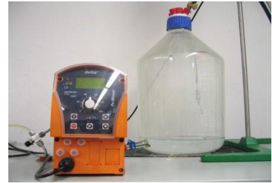
c) Behälter für flüssige Lösung und Dosierpumpe
