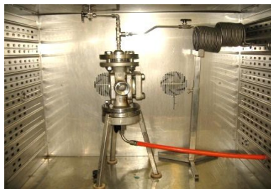
d) Prüfzelle mit Gasvorwärmung im Trockenschrank
