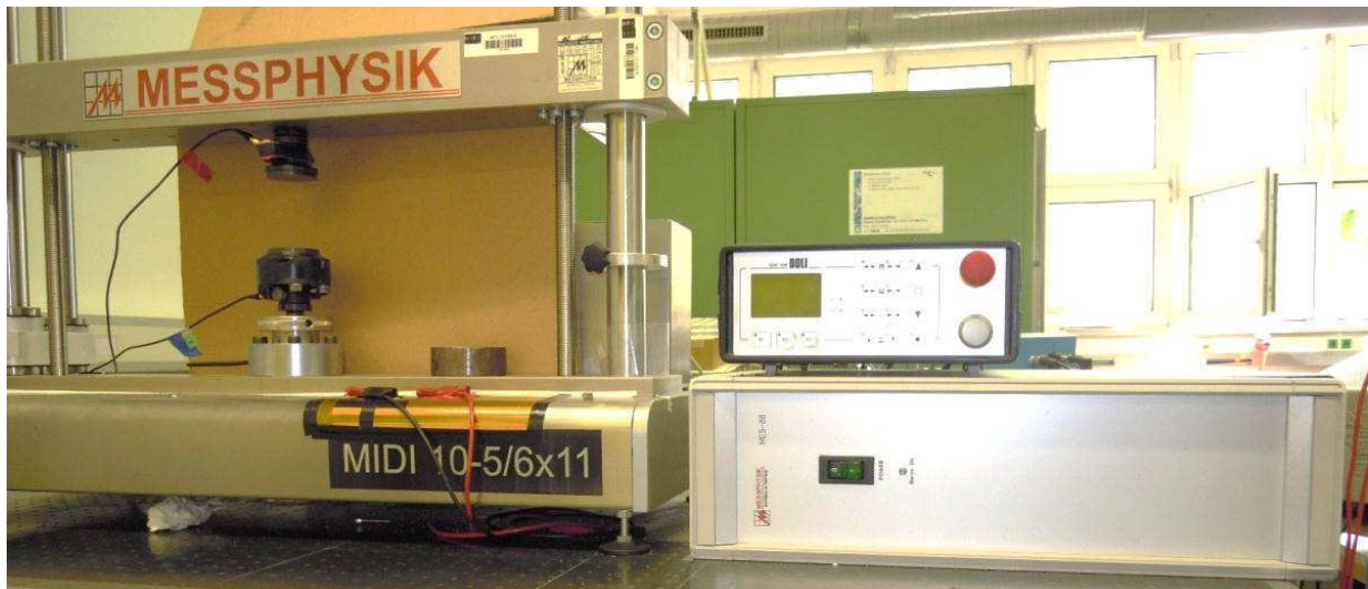
Abbildung 12: Universalprüfmaschine MIDI mit zugehöriger Mess- und Steuereinheit DOLI EDC 580 und dem Servoantriebsverstärker
