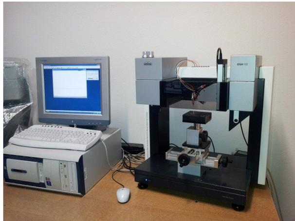
**Abb. 3.3:** Kontaktwinkelmessgerät DSA 100.
