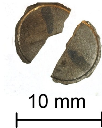
Abbildung 38: Halbierte und mit n=1/8 hochverformte Probe. Beide Teilstücke aus TNM2
