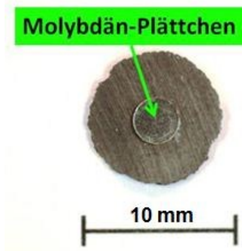
Abbildung 18: Deckfläche der verformten, zylindrischen Probe mit Molybdän-Abdeckung
