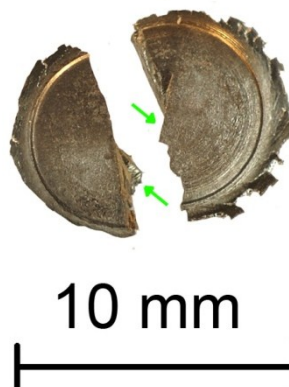
Abbildung 27: Halbierte und mit n=1/8 hochverformte Probe. Beide Teilstücke aus TNM1
