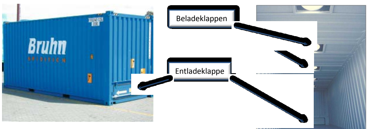
Abbildung 25: Außen- und Innenansicht eines ISO Bulk-Containers ohne Druckbehälter 17
