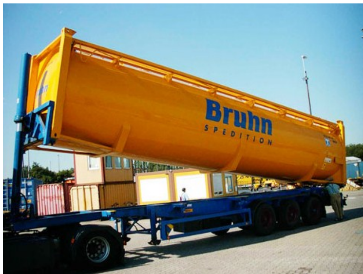
Abbildung 27: Entlademöglichkeit eines ISO Bulk-Containers mit Hilfe einer Kippvorrichtung 19
