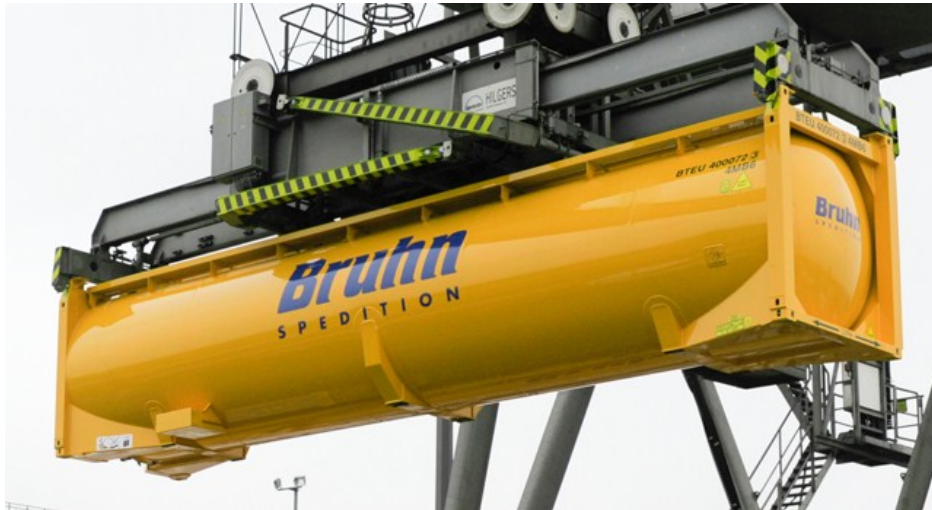
Abbildung 26: ISO Bulk-Container in Druckausführung 18
