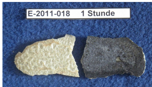
Abb. 24: Zunderschicht auf E-2011-018 nach 1 stündigem Erstarren bei 900°C
