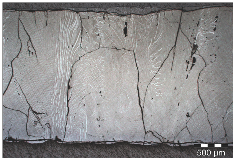
Abb. 48: Auflichtmikroskopische Darstellung der Gießschlacke E-2011-018 nach der Erstarrung für 10 Minuten bei 900°C
