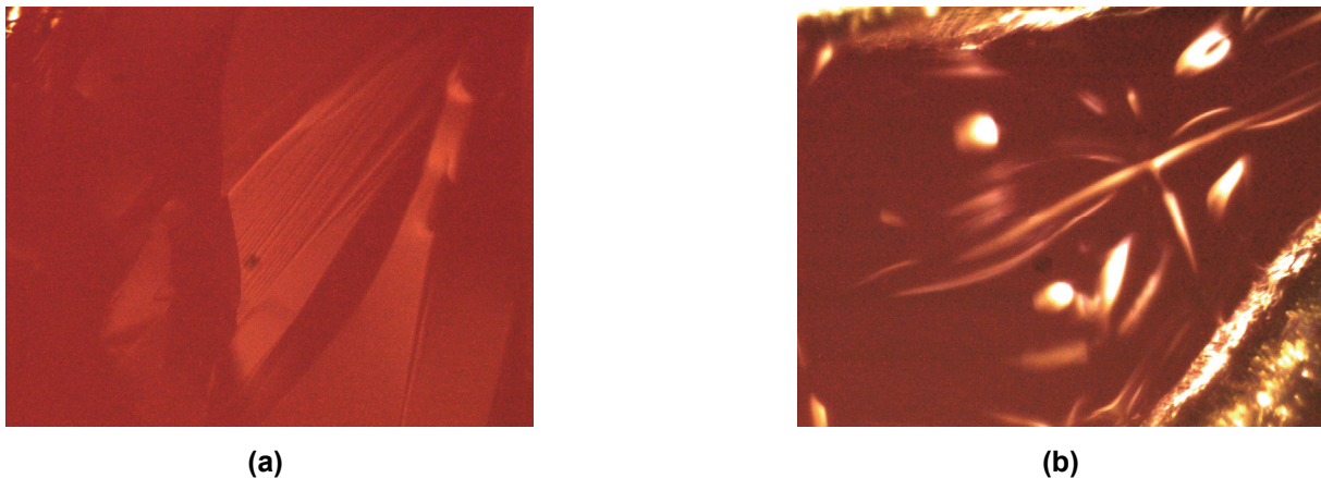
Abbildung 16: Originalschlacke mit Zusatz von 5% MnO bei (a) 1110°C und (b) 1050°C
