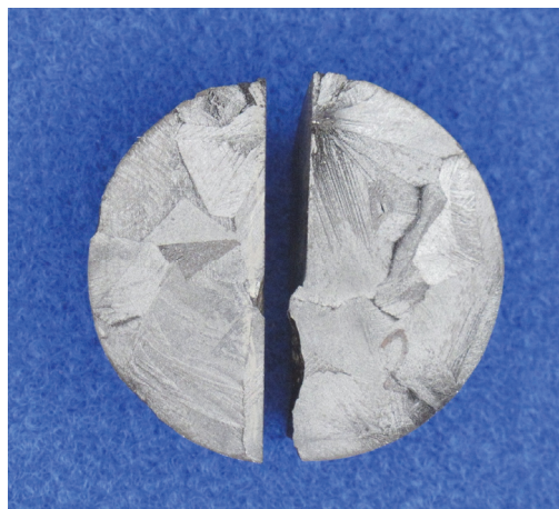
Abbildung 33: Probe mit 5% MnO-Zusatz nach Durchführung der Tiegelkristallisationsversuche
