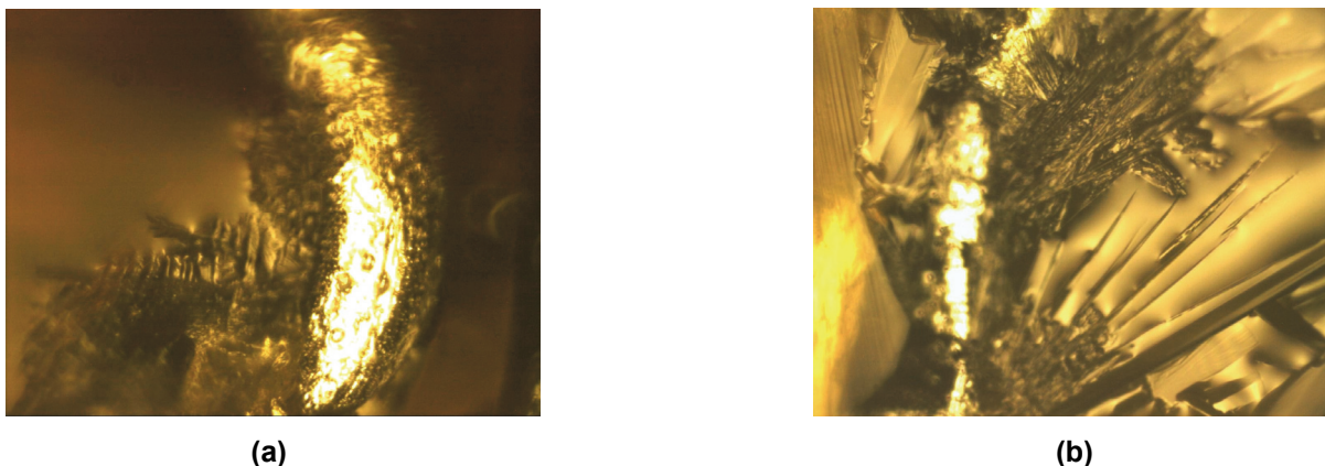
Abbildung 17: Originalschlacke mit Zusatz von (a) 1% Al 2 O 3 bei 1040°C und (b) 2% Al 2 O 3 bei 1020°C
