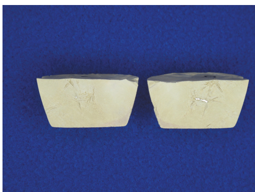
Abbildung 38: Probe mit 10% TiO_2 -Zusatz nach (a) Durchführung der Tiegelkristallisationsversuche und (b) auflichtmikroskopische Darstellung der Probe mit 10% TiO_2 -Zusatz bei 200-facher Vergrößerung
