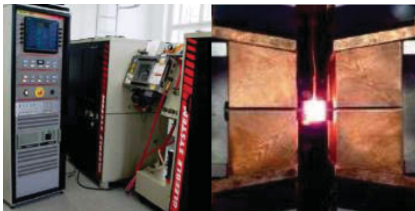
Abbildung 25: (a) Gleeble3800-Prüfsystem, (b) Kupferbacken mit stark erhitzter Probe (nicht aus dieser Arbeit) [58]
