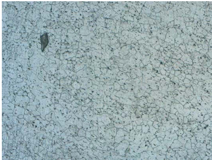
Abbildung 38: Korngefüge der AZ31-Legierung nach einer Glühzeit von 15 Minuten
