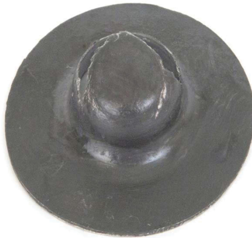
Abbildung 36: Näpfchenprüfling mit typischem Versagensprofil [51]
