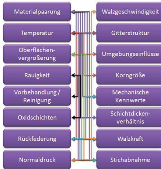
Abbildung 5: Zusammenhänge zwischen den wichtigsten Herstellungs- und Systemparametern beim Walzplattieren [50]
