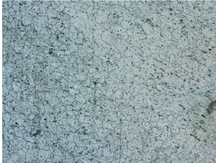
Abbildung 37: Korngefüge der AZ31-Legierung nach einer Glühzeit von 10 Minuten
