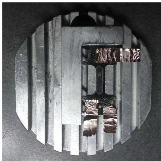
Abbildung 4.1.: Probenhalter mit formschlüssig fixiertem Winkel. Die Zugprobe wird an diesen Winkel angelegt und mit Kupferband vor zu starker Aufladung geschützt. Diese Halterung wurde auch für EBSD-Messungen verwendet.
