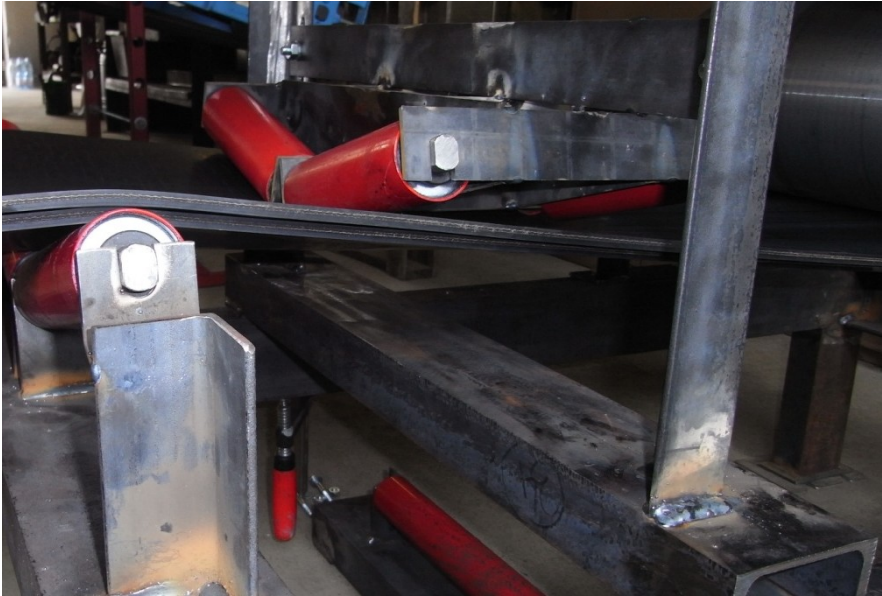
Abbildung 68: Versuchsstand Niederhalter zwischen Rollenstuhl 3 und AT2
