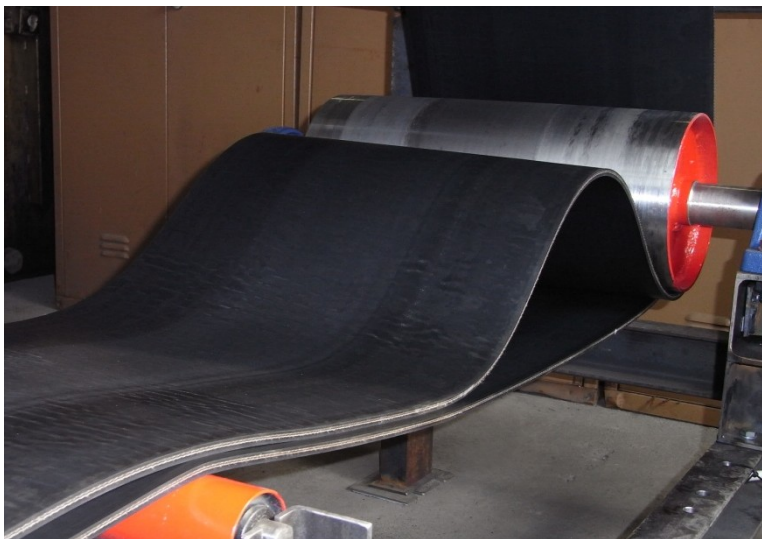
Abbildung 64: Versuchsstand Gurtstau vor Antriebstrommel 2
