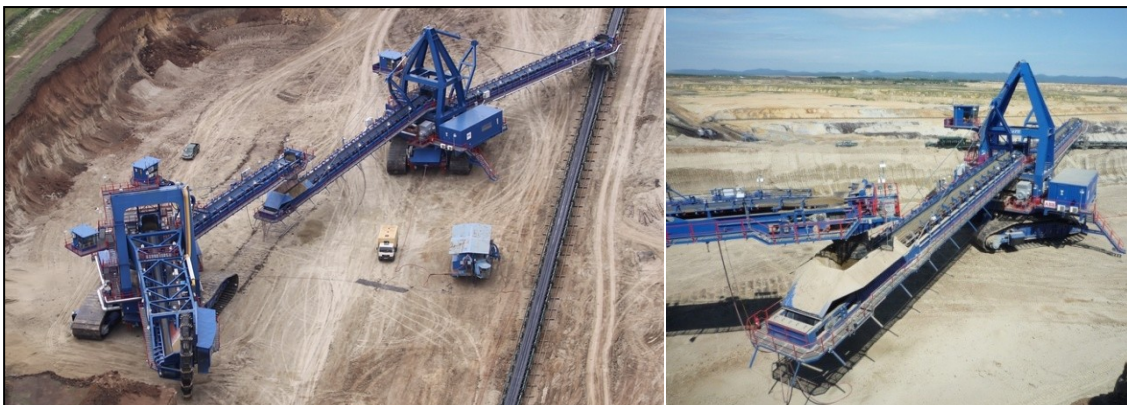
Abbildung 24: Schaufelradbagger und Bandwagen im Zusammenspiel 25
