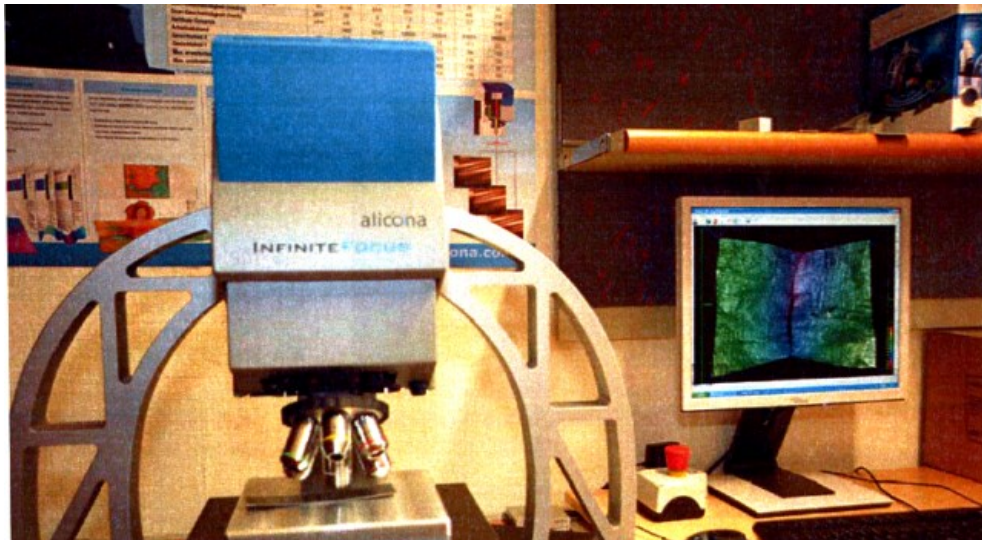
Abbildung 3-20: Alicona Infinite Focus 4G: Messgerät für die 3D-Oberflächenrauigkeit
