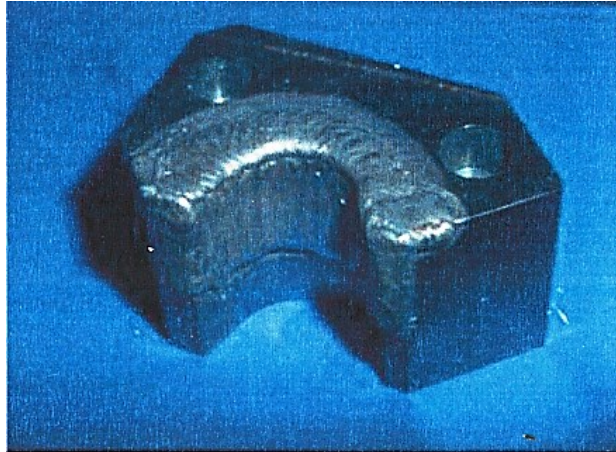
Abbildung 2-25: Warmschermesser mit Nickelbasis aufgeschweißt [VIL11]
