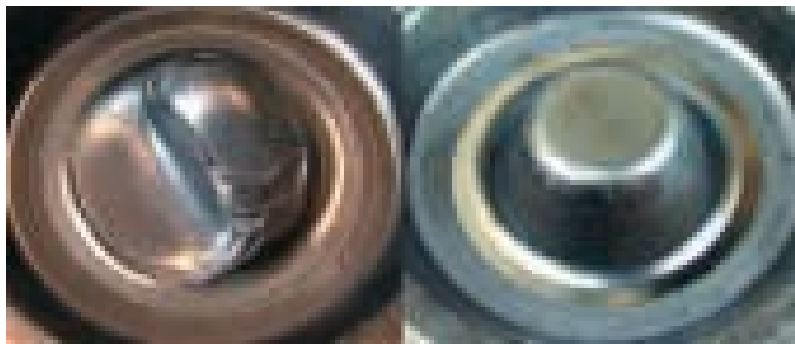
Abbildung 2-44: WC-Mittelkorn Hartmetall mit 12% -Co als Bildner [BAR01]; links: Vorzeitiges Versagen nach 218 Zyklen mit Kühlschmierung, rechts: ohne Kühlschmierung nach 500 Zyklen mit adhäsiver Verschleiß im Dornbereich (Schmiedetemperatur 1200 °C) [BAR01]
