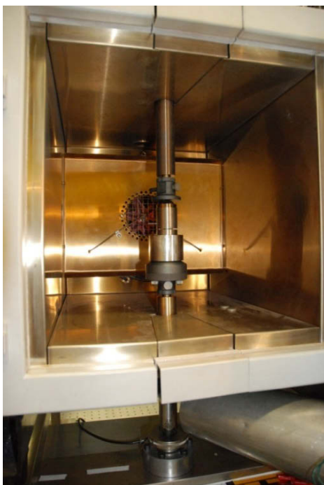
Abb. 5.3: Temperaturkammer bei geöffneter Tür, die Stempel der Spindelprüfmaschine werden durch Ausnehmungen in das Innere geführt. Zwischen den Stempeln ist das Auflager zu sehen, welches zusätzlich auf einen Metallblock gestellt werden musste um die notwendige Höhe zu erreichen.
