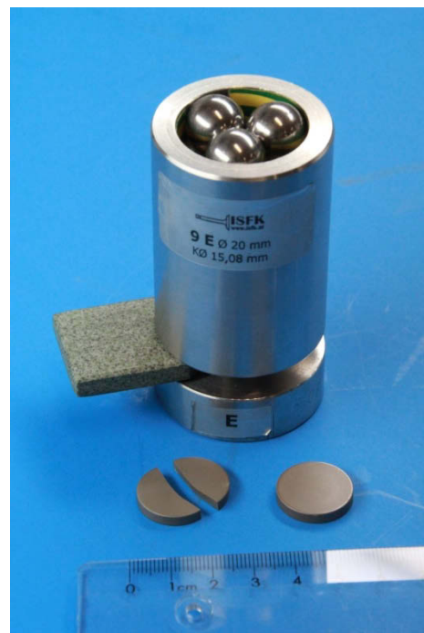
Abb. 5.2: 4-Kugel-Lager für B3B-Prüfung bei Raumtemperatur mit gebrochener und ungebrochener PTC-Scheibe (Bezeichnung: 9E)
