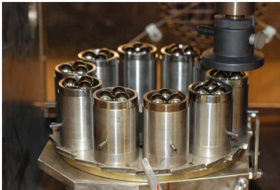
Abb. 5.18: Blick in die Temperaturkammer bei geöffneter Tür: Zehn "HT"-Auflager sind auf einer drehbaren Scheibe positioniert. Die Scheibe kann durch Hebel, die durch Ausnehmungen aus der Temperaturkammer ins Freie führen, bedient werden.
