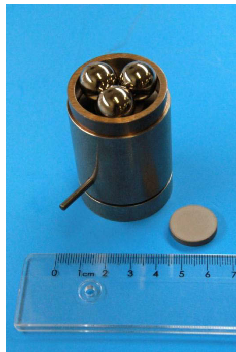
Abb. 5.4: Lager für B3B-Prüfung in der Temperaturkammer mit PTC-Scheibe (Bezeichnung: HT)
