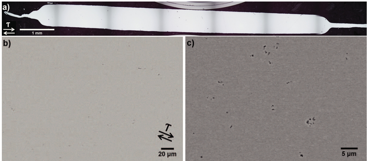
Abbildung 6.36 Aluminiumprobe, die bei 170°C druckgeglüht wurde. a) Übersicht, b) raster-elektronenmikroskopische Aufnahmen der Probe bei r = 2 mm und c) vergrößert bei r = 2 mm.
