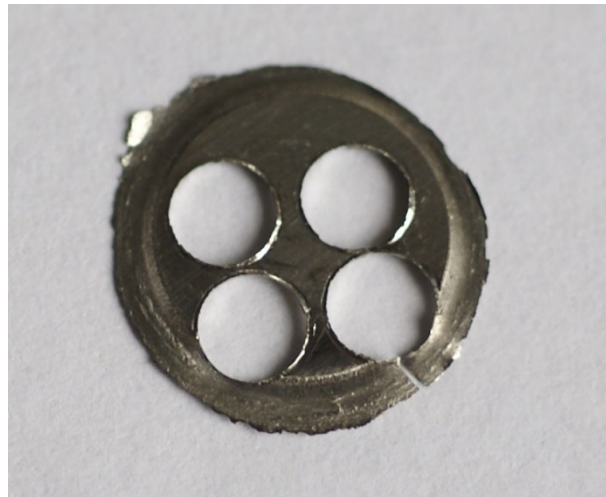
Abb. 7) Entnahmestellen der TEM-Proben, die Blickrichtung im TEM liegt dabei parallel zu Verformungsachse
