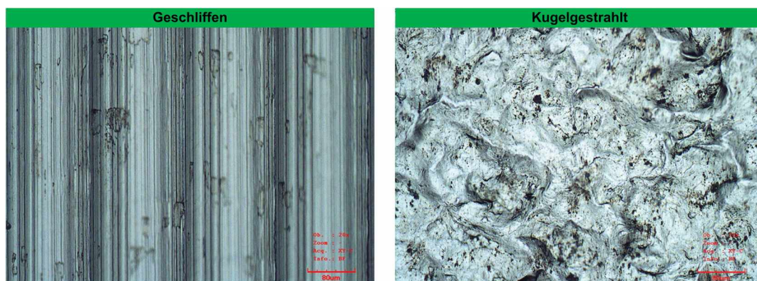
Abbildung 2.8: Vergleich einer geschliffenen und einer kugelgestrahlten Oberfläche
