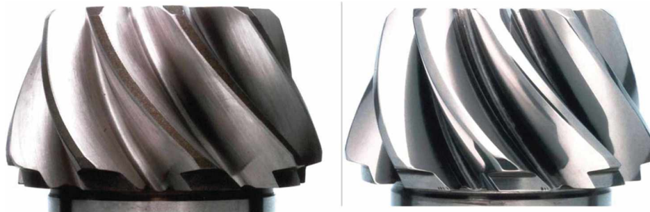
Abbildung 2.10: Optische Auswirkung des Gleitschleifens [Win11]
