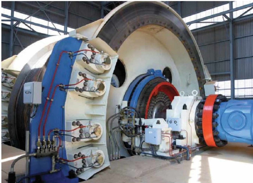
Abb.2. 15 Scheibenbremse für Trommel-Fördermaschine
