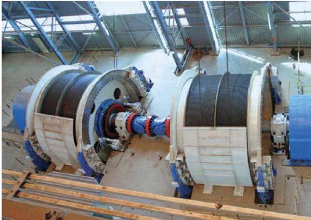
Abb.2. 11 Blair-Doppeltrommel-Fördermaschine aus SIEMAG-TECBERG 3
