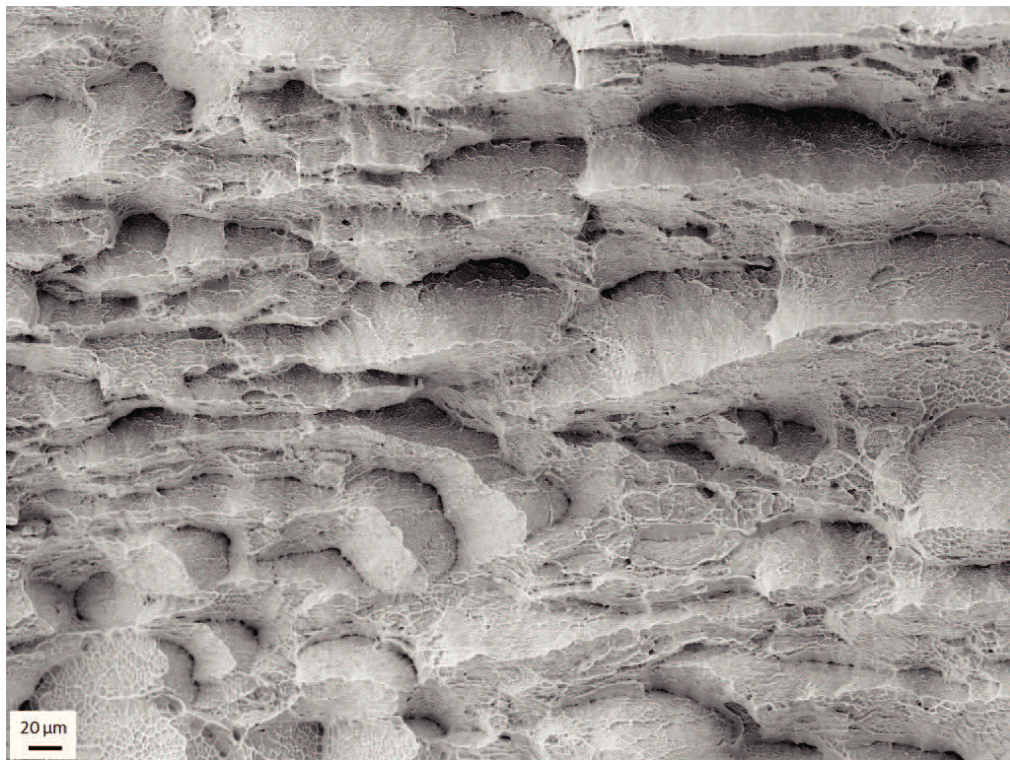
Abb. 3.46.: Ti13Zr13Nb B: stufenförmige Bruchstruktur
