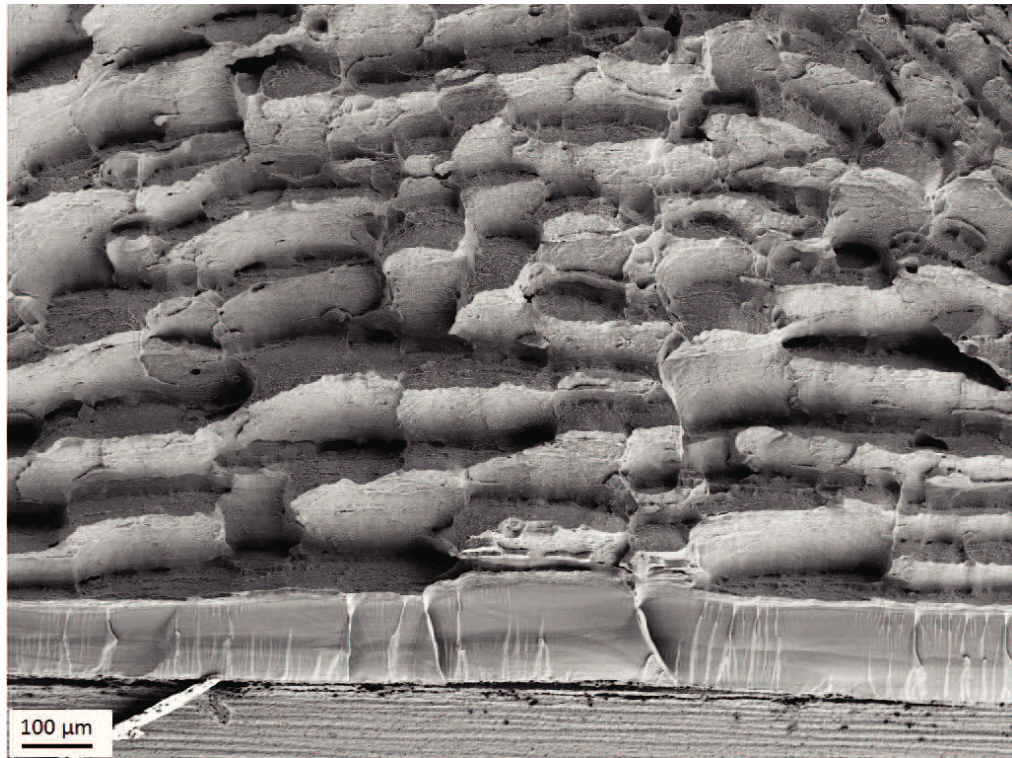
Abb. 3.36.: Ti45Nb B: Überblick über Anriss, Stretch-Zone und stufenförmige Bruchstruktur
