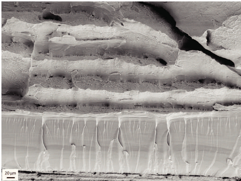
Abb. 3.37.: Ti45Nb B: Detailaufnahme von Anriss und Stretch-Zone
