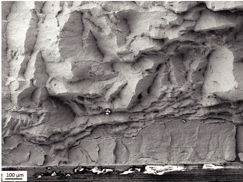
Abb. 3.45.: Ti13Zr13Nb B: Anriss und Restbruch
