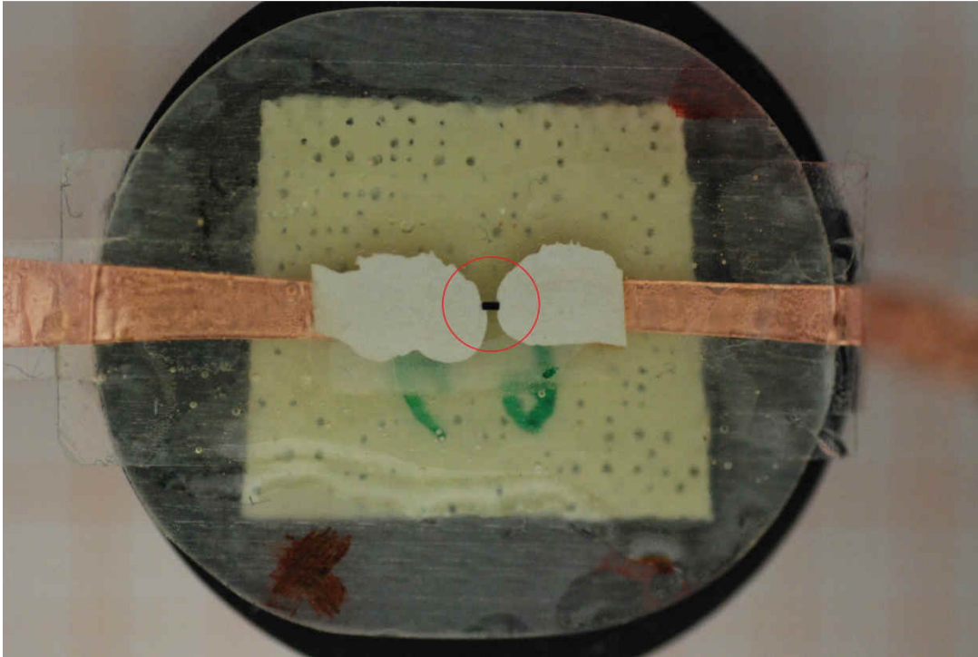
Abbildung 28: Elektrisch kontaktierte Probe vorbereitet für die Freilegung des dominierenden Strompfades. Die Lage des Varistors ist mit einem roten Kreis markiert
