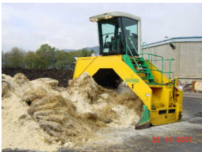
Foto 6-1 Pferdemit/Stallstreu und Lederspäne werden mit dem Mietenwender vermisch
