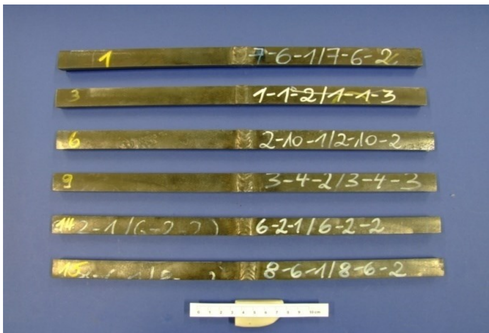
Abbildung 24: Vormaterial für externe Probenfertigung der CLT- und SSC-Proben
