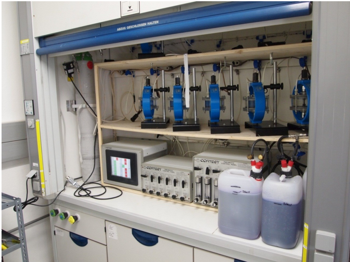
Abbildung 33: Sauergasprüfstand für Method A-Tests
