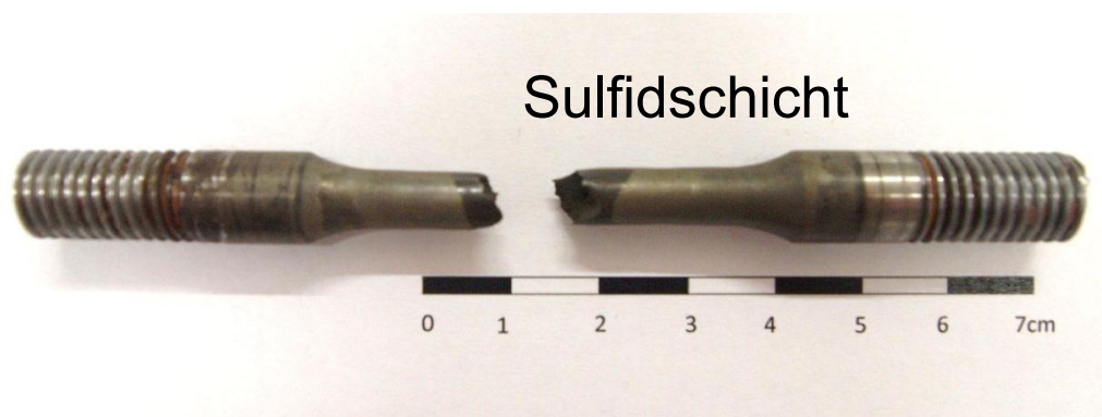
Abbildung 49: SSC-Probe mit Bruch in der Schweißnaht
