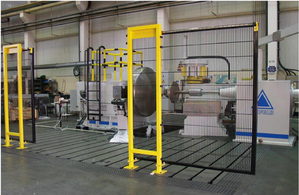
Abb. 2.16: Leifeld-SC-235 in Modulbauweise bis 3,5 m Rondendurchmesser (Quelle: Leifeld Metal Spinning AG)
