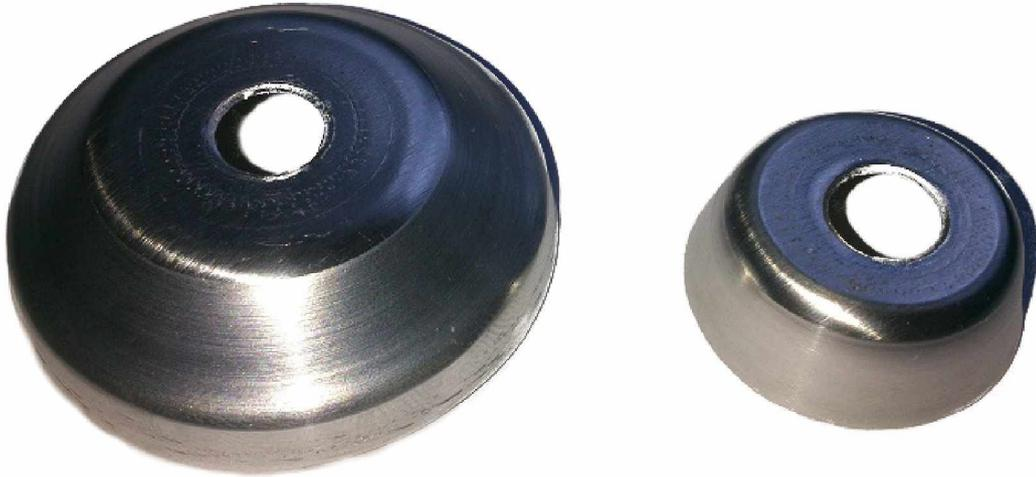
Abb. 4.8: Herstellbare Werkstückvarianten (Links: Kegel 50°, Rechts: Kegel 15°)
