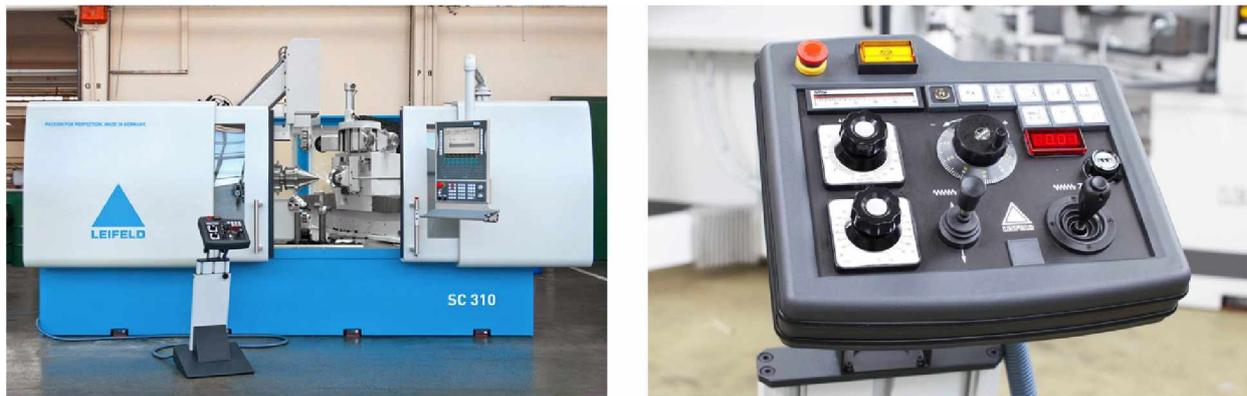
Abb. 2.15: Spinning Center Leifeld-SC-310 mit Playback-CNC-Steuerung (Quelle: Leifeld Metal Spinning AG)
