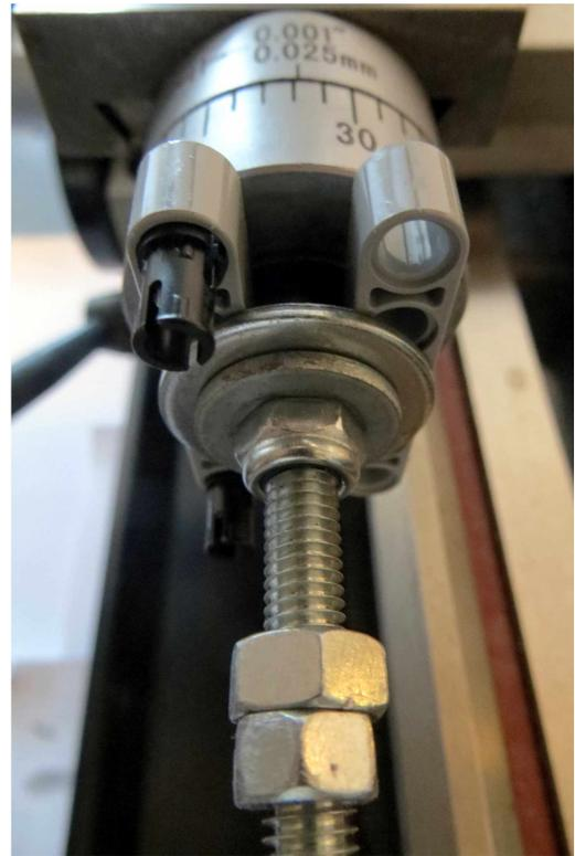
Abb. 3.17: Links: Gewindestange mit Muttern für Querschlittenantrieb, Rechts: Gewindestange mit Kleinteilen und LEGO-Elementen für Oberschlittenantrieb
