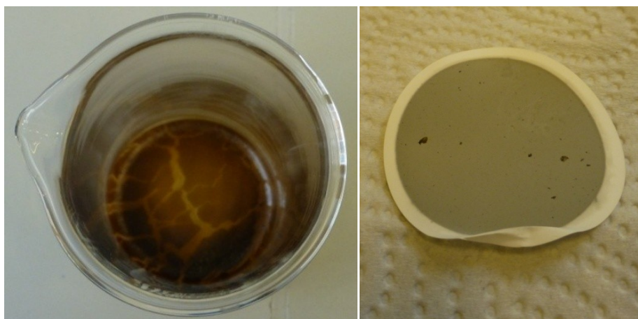
Abbildung 8: links: Abdampfrückstand eines Eluates; rechts: 0,45 µm-Filter nach der Filtration des Eluates für den Abdampfrückstand
