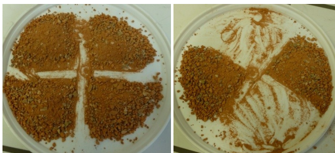
Abbildung 35: Viertelung der Gesteinsproben
