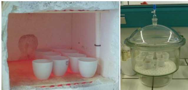
Abbildung 36: Muffelofen bei 815\text{ °C} & Exsikkator ohne Silikagel für die Bestimmung des Aschegehalts der Gesteinsproben
