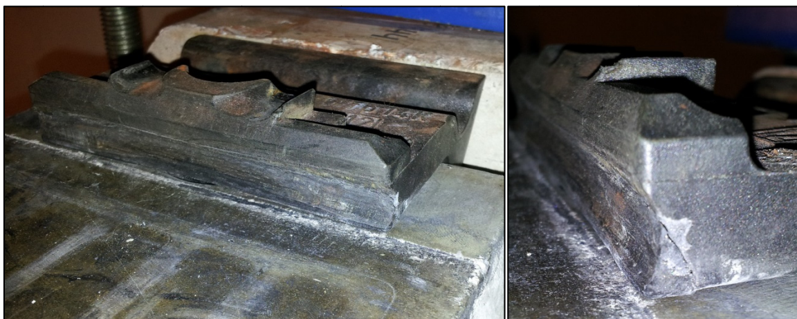
Abb. 4.30: Schädigung der Winkelführungsplatte durch fehlerhafte Krafteinleitung.
