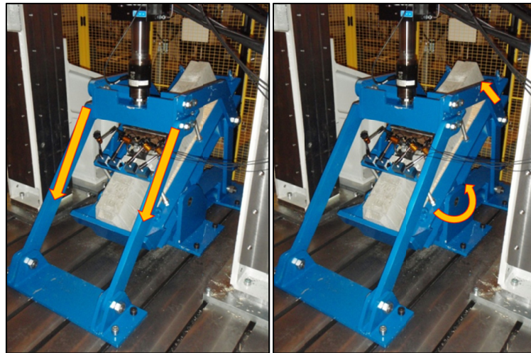
Abb. 3.19: Darstellung der Bewegung des Prüfstandes bei dynamischer Belastung.
