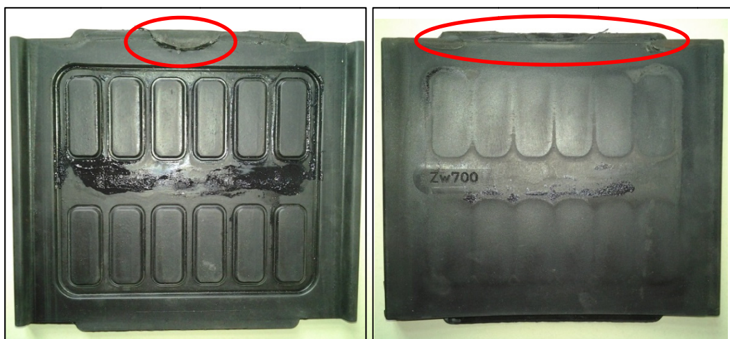
Abb. 4.22: Prüfplatte ZW 700 - Probe 1 nach dem Dauerschwingversuch.
