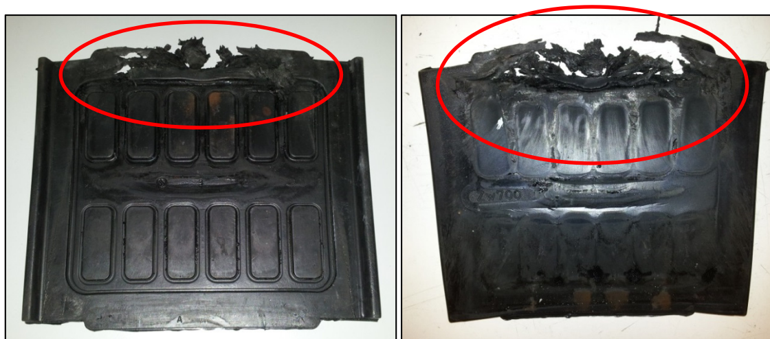
Abb. 4.34: Zusätzliche Prüfplatte ZW 700 nach dem abgebrochenen Dauerschwingversuch.
