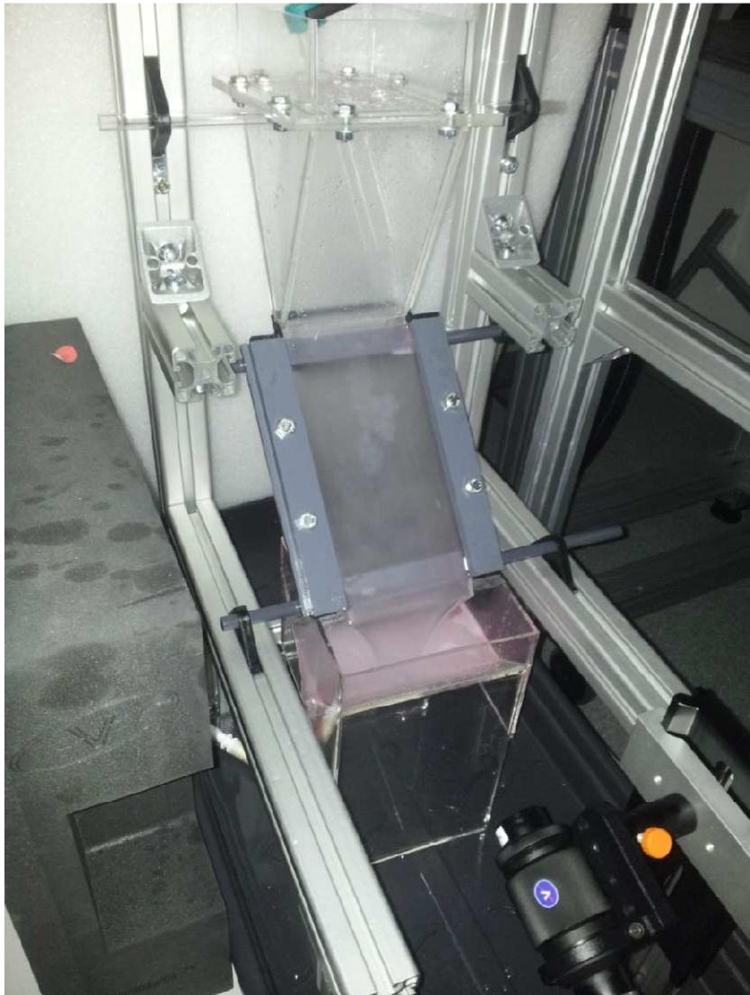
Abbildung 24: Rieselfilm von Silikonöl M 20 entlang der Plexiglasplatte (Anstellwinkel 60 Grad) bei einem Volumenstrom von 1900 ml/min.
