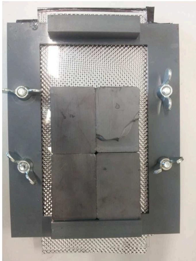
Abbildung 16: Blockmagnete zur Befestigung des strukturierten Metallblechs.
