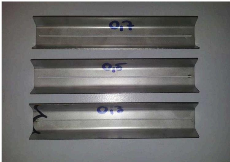
Abbildung 15: Aluminiumbleche mit gelasertem Spalt.
