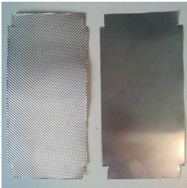
Abbildung 17: strukturiertes und glattes Metallblech.
