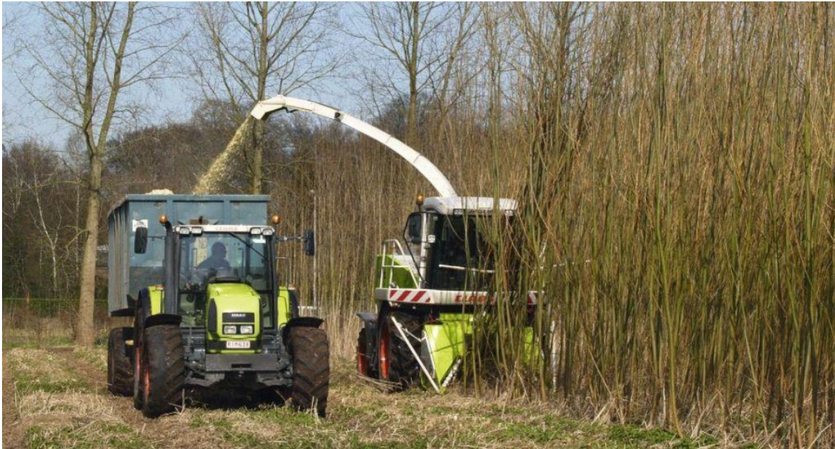
Abbildung 7: Moderne Erntemaschinen mit integriertem Häckselsystem, Sammelcontainer extra [20]
