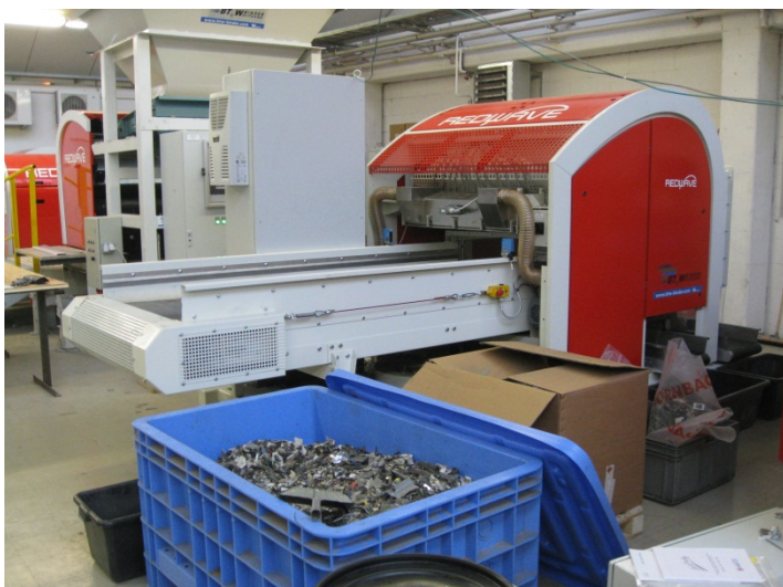
Abbildung 3-23: NIR-Sortierapparat „Redwave“ der Firma BTW-Binder
