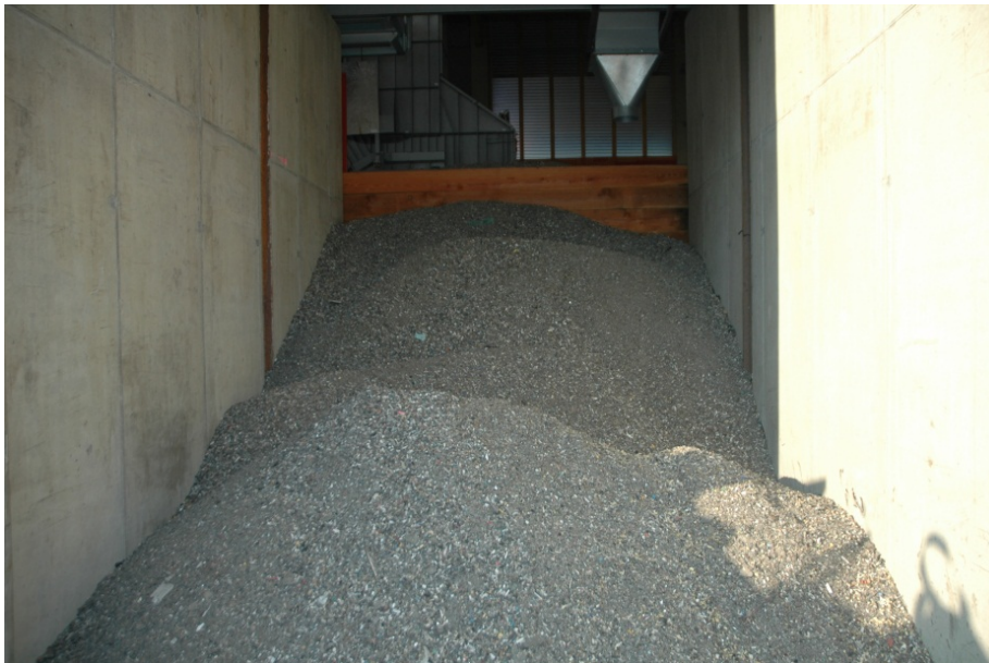
Abbildung 3-4: Gesammelter Feinanteil im Bunker
