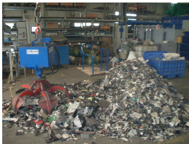
Abbildung 3-11: Spänezerkleinerer - „Arno Shred“ mit dem aufzugebenden Gut
