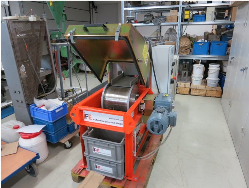
Abbildung 3-9: Trommelmagnetscheider der Firma IFE
