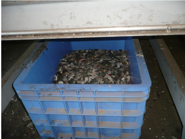
Abbildung 3-13: Sammelbox unter dem Spänezerkleinerer
