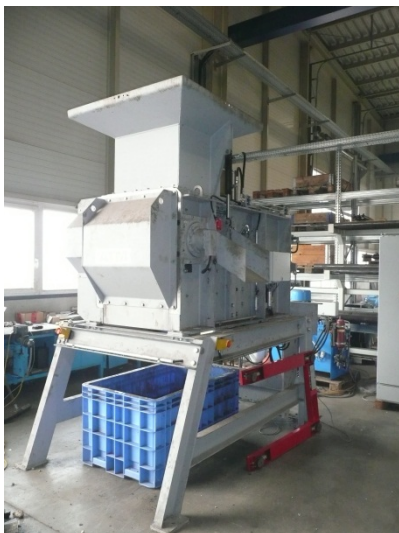
Abbildung 3-11: Spänezerkleinerer - „Arno Shred“ mit dem aufzugebenden Gut
