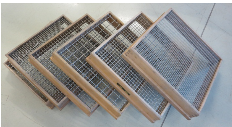
Abbildung 3-24: Verwendete Siebe für die Siebanalyse des Durchlaufs
