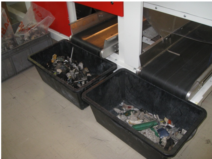
Abbildung 3-22: Auswurfboxen des NIR-Sortierapparates „Redwave“
