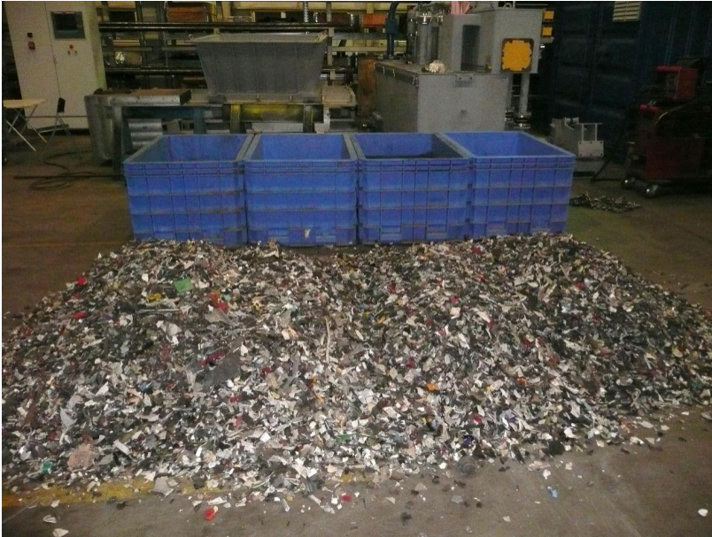
Abbildung 3-16: Probenteilung durch "Schaufelmethode" des Feinanteils
