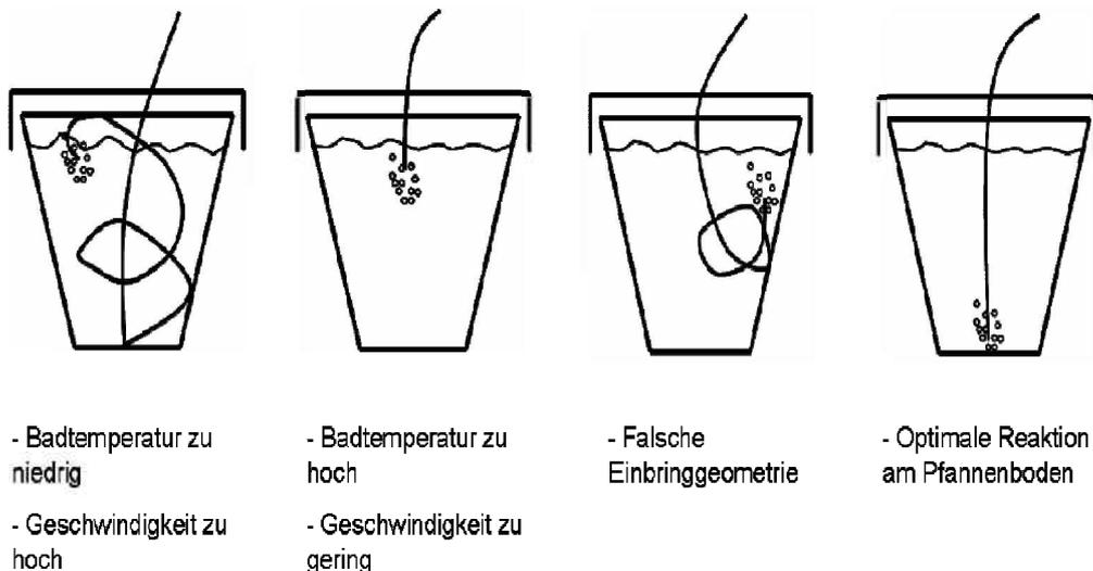
**Abbildung 2-35:** Verhalten des Drahtes beim Einbringen in die Pfanne [49].
