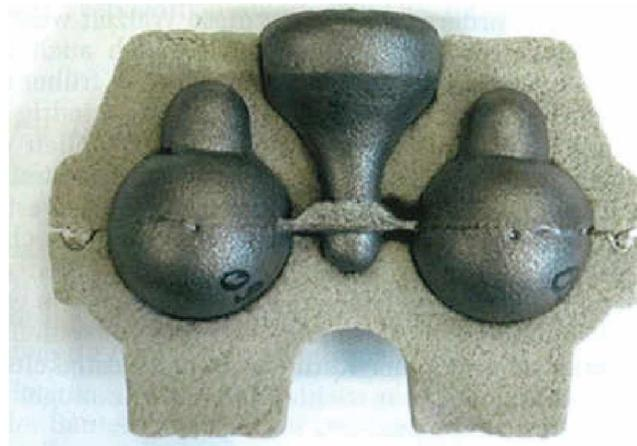
**Abbildung 3-11:** Schnitt des Probentiegels von OCC mit zwei Kammern und einem Eingusssystem [64].
