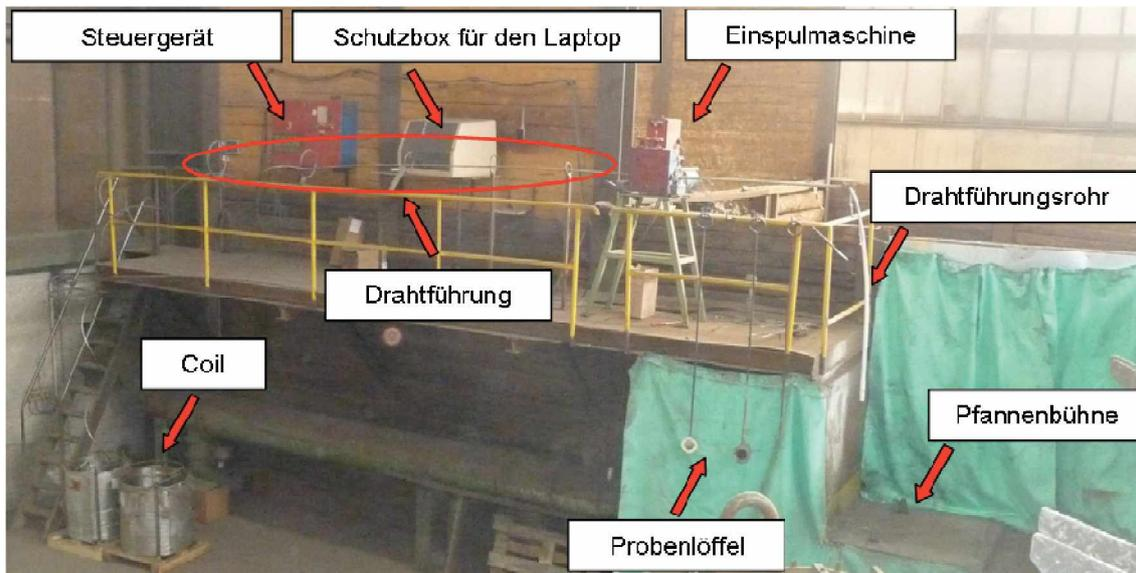
**Abbildung 3-4:** Die Drahteinspulsbehandlungsstation, die für die Magnesiumbehandlung verwendet wurde.
