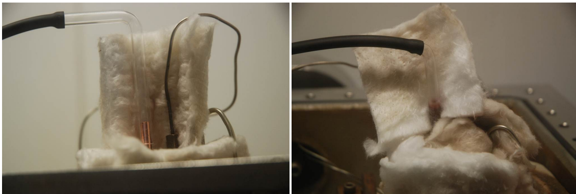
Abbildung 5.15: Versuchsanordnung zur Selenverdampfung (links: Beginn der Selenverdampfung; rechts: Beginn des Selendampfaustritts aus der Verdampfungskammer)
