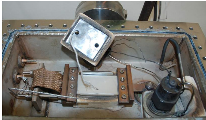
Abbildung 5.16: Darstellung der gesputterten CIG-Probe
