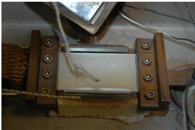
Abbildung 5.18: CIG-Probe vor der Selenisierung
