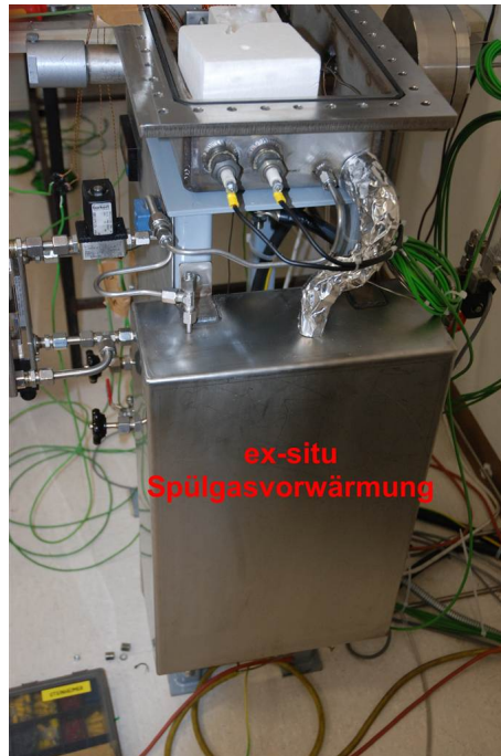
Abbildung 4.6: Darstellung der Ex-situ-Spülgasvorwärmung
