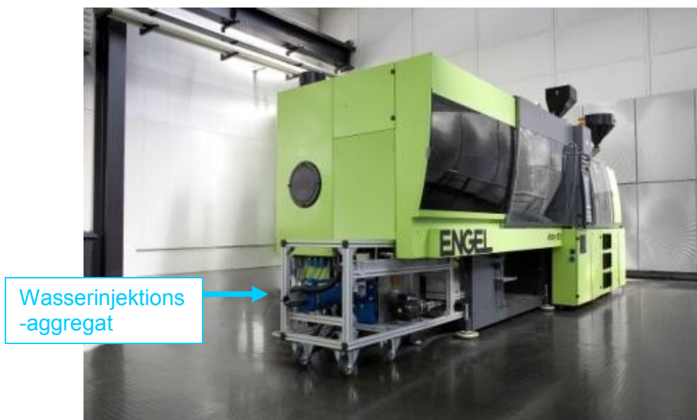
Abbildung 7: Spritzgießmaschine mit integriertem Aggregat für die Wasserinjektion
