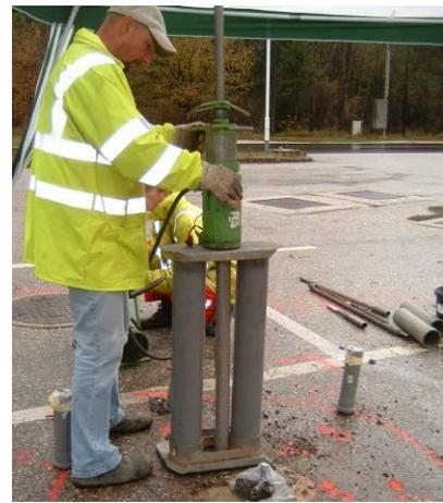
Abbildung 38: links: Probenahme aus der Sonde; rechts: Vorrichtung zum Ziehen der Rammkernsonde
