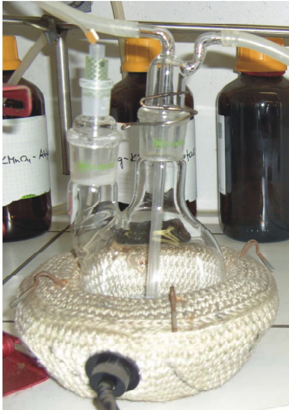
Abbildung 4-16: 2-Hahn-Kolben mit kleinerem Reaktionsvolumen
