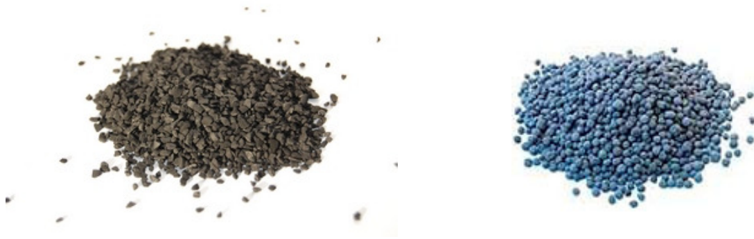
Abbildung 3-6: Adsorptionsmittel Aktivkohle (links) und Sorbalit (rechts) [25], [26]
