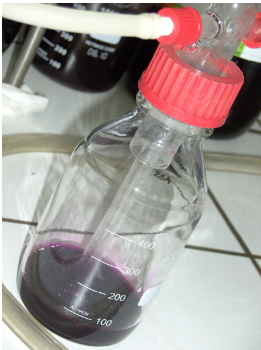
Abbildung 4-2: Waschflasche mit schwefelsaurer Kaliumpermanganatlösung zur anschließenden Analyse mittels ICP-MS
