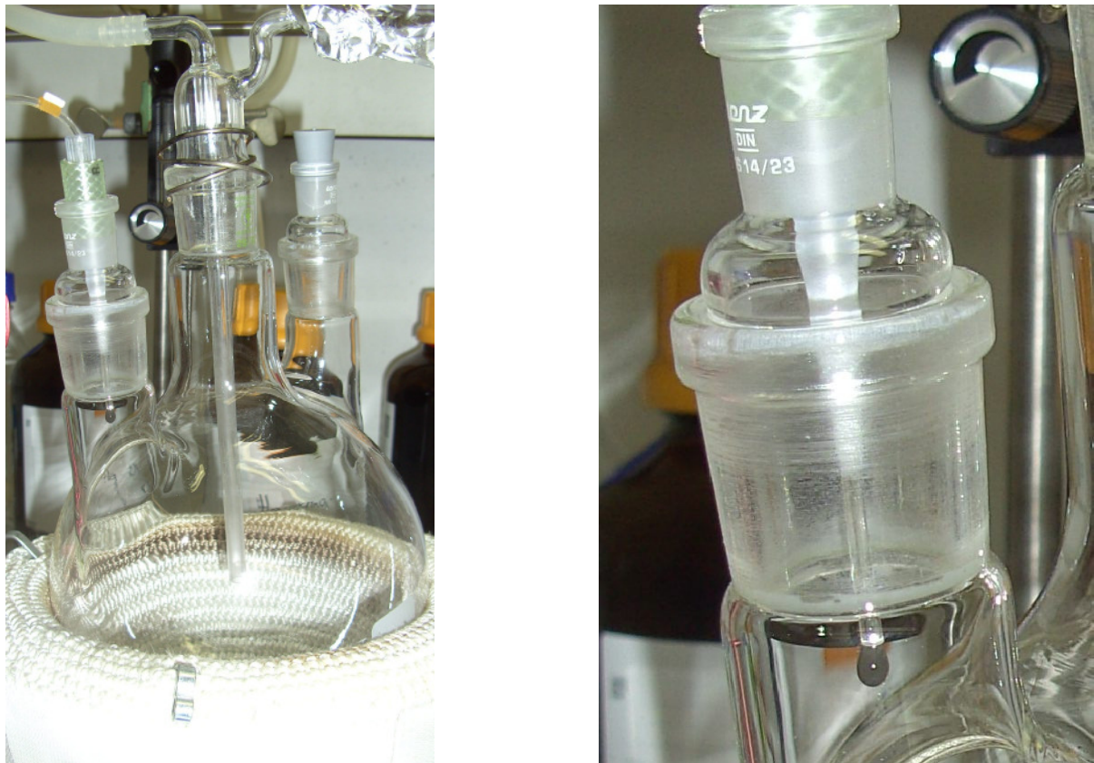
Abbildung 4-13: Zutropfen der Hg-Lösung in den Reaktionskolben
