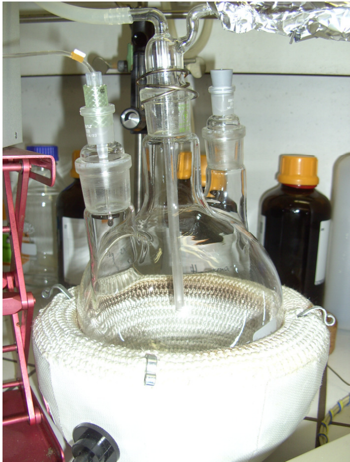
Abbildung 4-17: Erwärmung des 3-Hahn-Reaktionskolbens mittels Heizpilz
