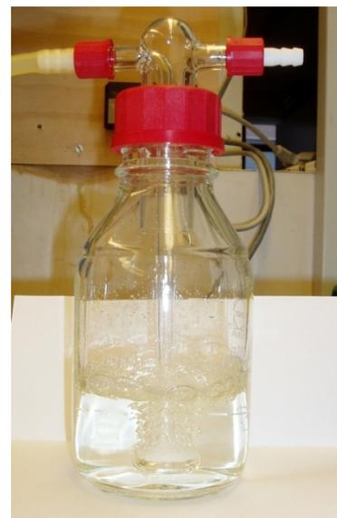
Abbildung 61, 62 und 63: Ozonierung über Zylinder, Kugel und Gaswaschflasche mit Glasritze
