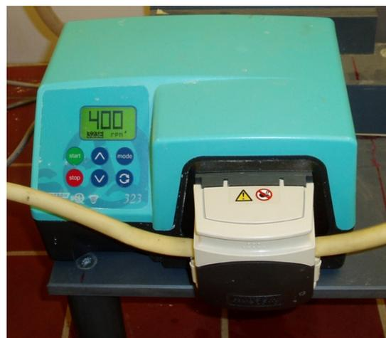
Abbildung 71: Schlauchpumpe sciQ 323
