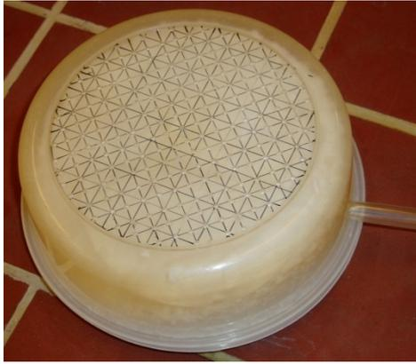
Abbildung 72: Füllkörperbehälter Tupperbox mit PTFE-Füllkörpern und Ozoneindüsung
