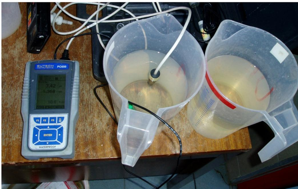
Abbildung 84: Vor-Ort Messung der Summenparameter mittels PC-650 Messgerät
