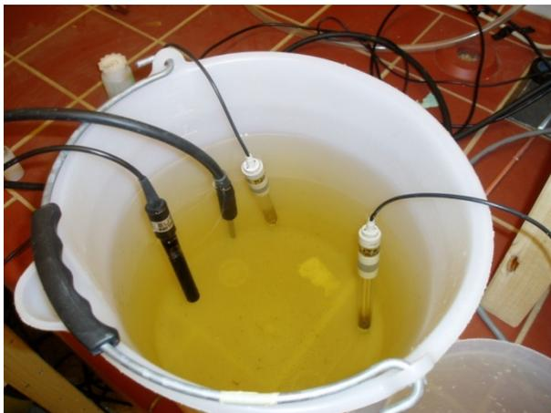
Abbildung 27: Messsensoren zur Bestimmung diverser Summenparameter
