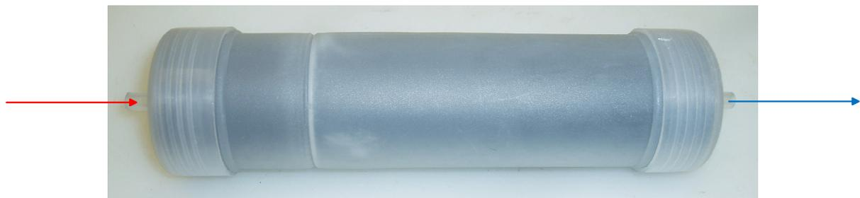
Abbildung 16: Ozonvernichter mit Aktivkohlefüllung
