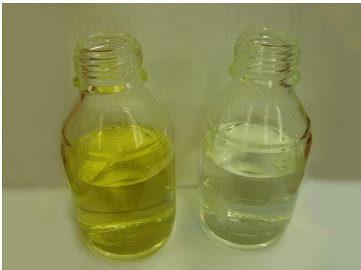
Abbildung 35: Vergleich zwischen unbehandeltem (links) und ozoniertem Abwasser (rechts)
