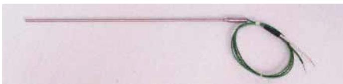
Abbildung 40: Thermoelement Typ K [22]
