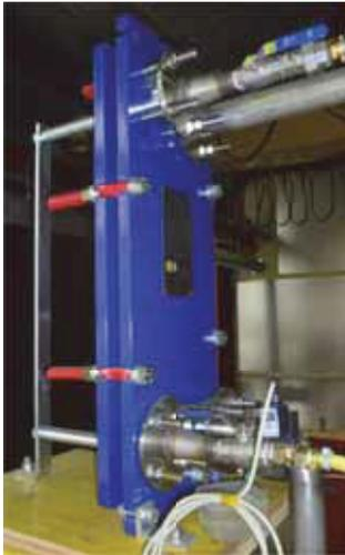
Abbildung 62: Kondensator
