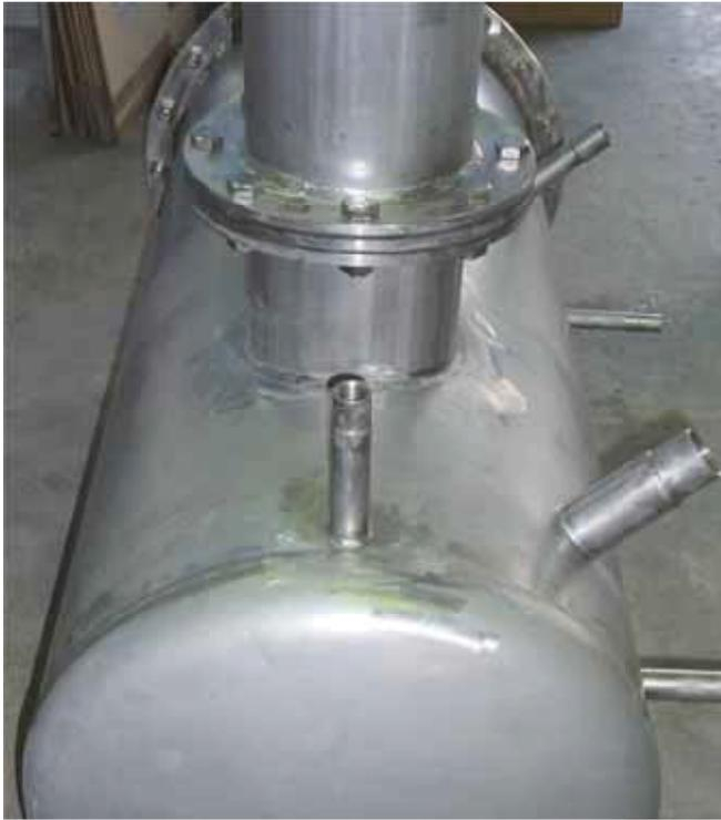
Abbildung 58: Sumpftank mit DN200-Stutzen
