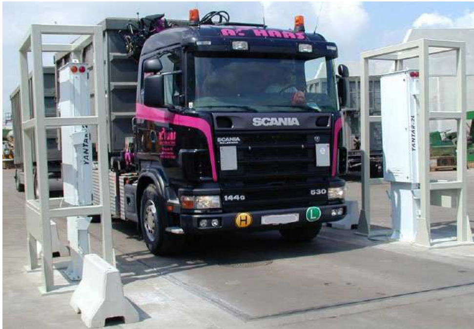
Abbildung 52: YANTAR-2L Schrottmonitor zur Überwachung von Lastkraftwagen [43]
