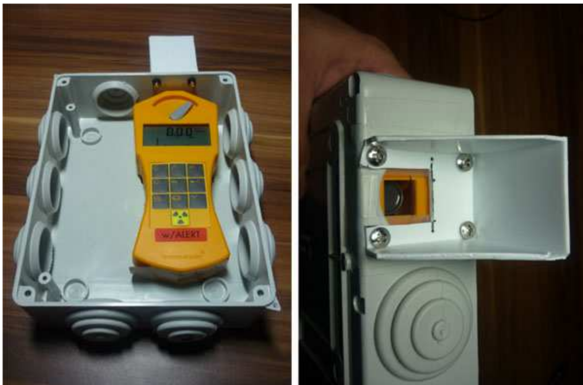
Abbildung 21: Einbau des Messgerätes
