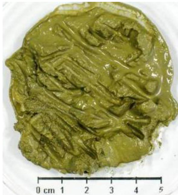
Abbildung 4-9: Rückstand aus der Eisenfällung (Jarositfällung)
