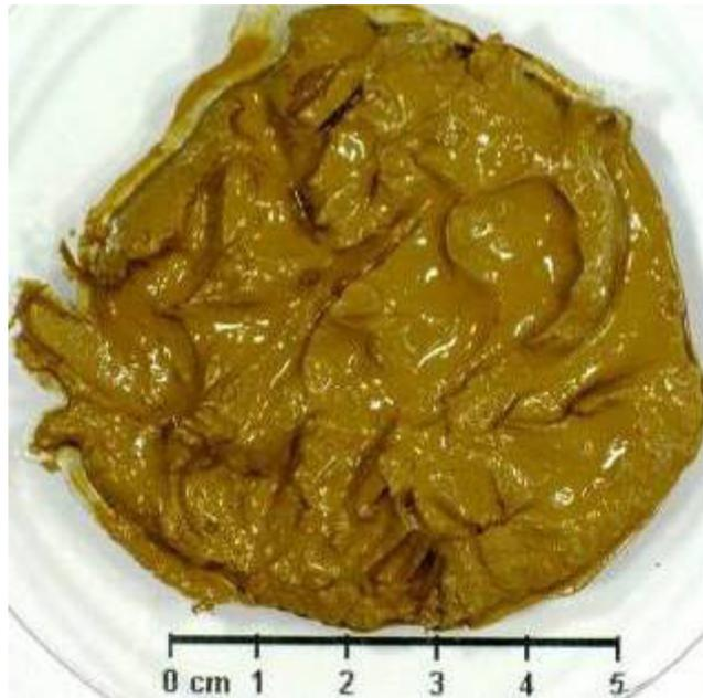
Abbildung 4-14: Rückstand aus der Eisenfällung (Jarositfällung)
