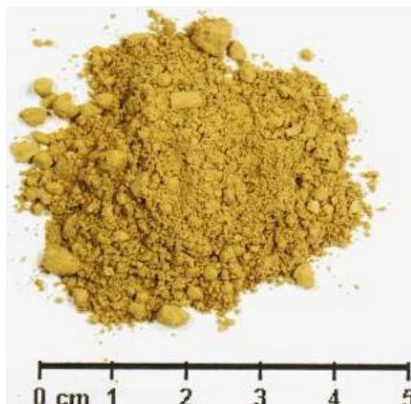
Abbildung 5-2: Jarosit-Rückstand nach der Waschung
