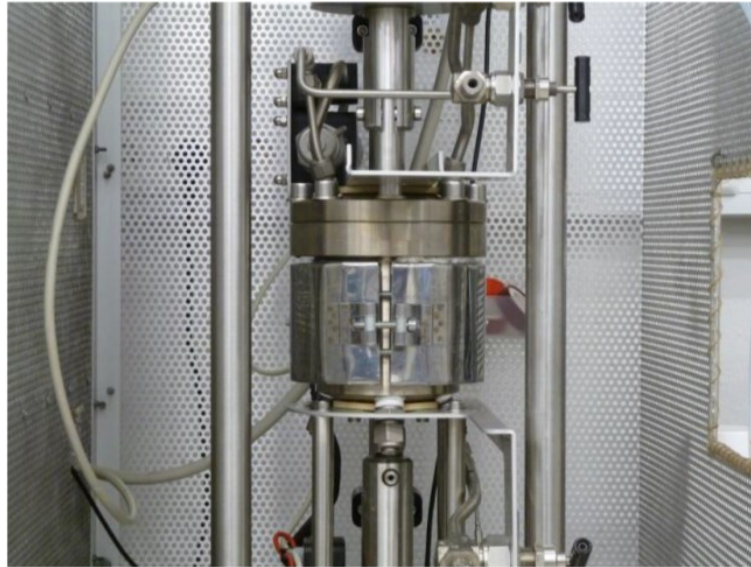
Abbildung 18: Versuchsaufbau eines Langsamzugversuchs bei 12 bar
