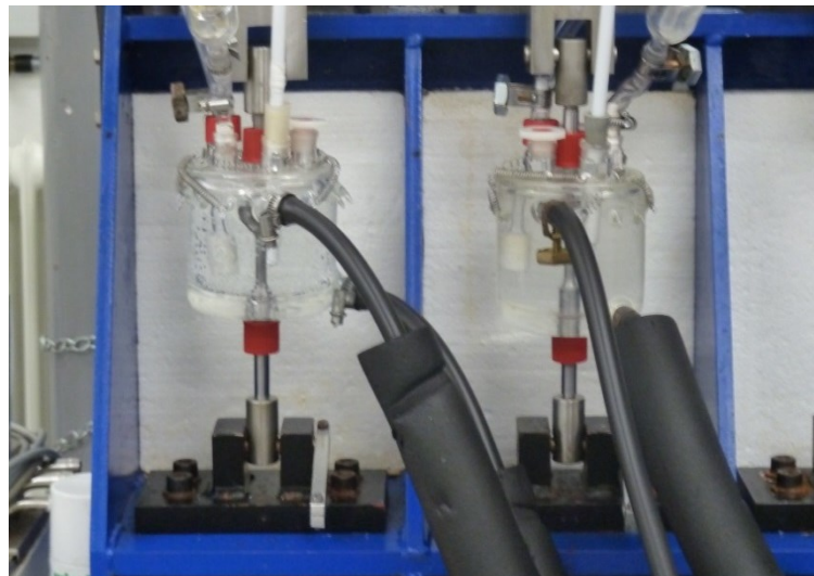
Abbildung 19: Versuchsaufbau für Tests unter konstanter Last
