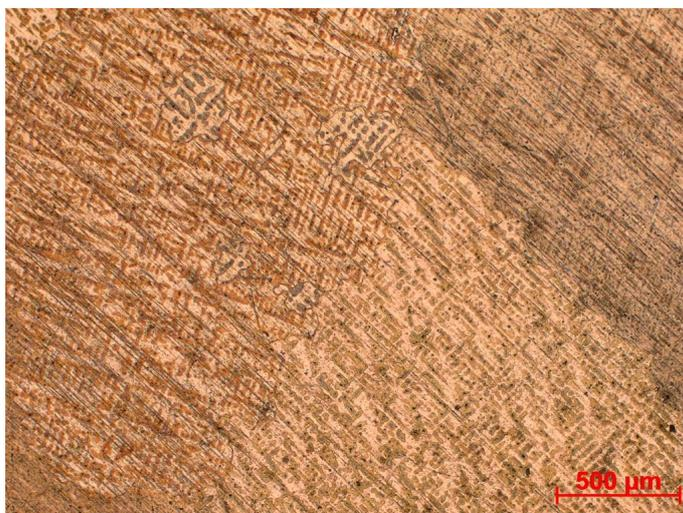
Abbildung 41: Gefügebild der makrogeätzten CuSn11Pb2-Probe
