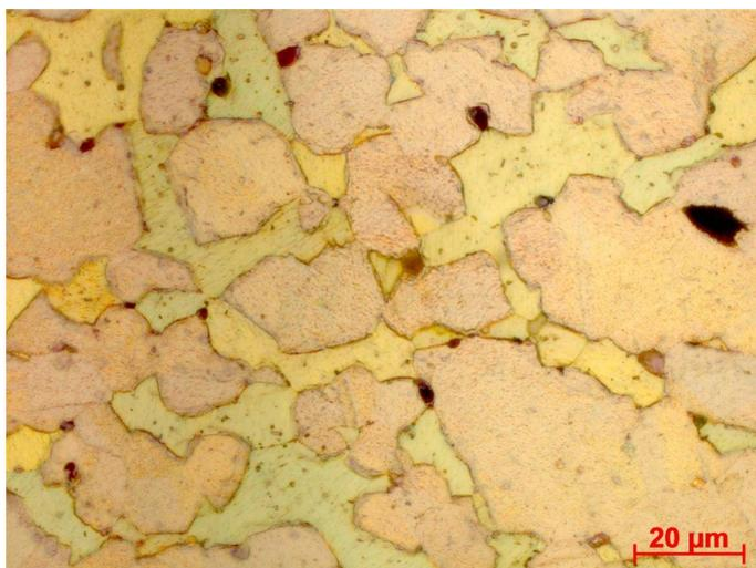
Abbildung 52: Gefügebild der makrogeätzten CuZn39Pb3-Probe
