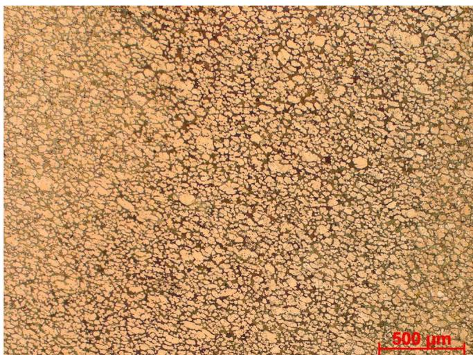
Abbildung 46: Gefügebild der mikrogeätzten CuZn39Pb3-Probe
