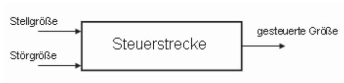
**Abbildung 6: Wirkungsprinzip der Steuerung**<sup>40</sup>
