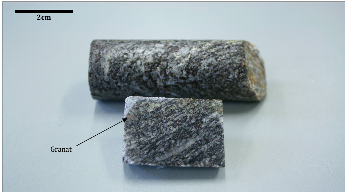
Abb. 28: Glimmerschiefer GS1, Bohrkern UB9 Ost 19, Kiste 12, Bohrmeter 61,1
