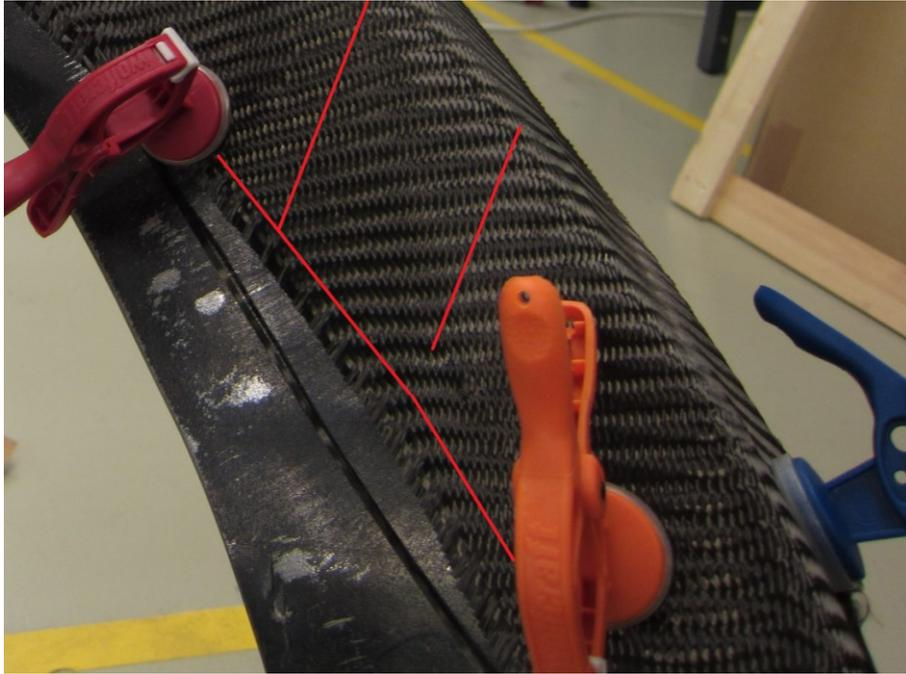
Abbildung 64: Köpergewebe auf Profil 4: Trellis Effekt Innenseite
