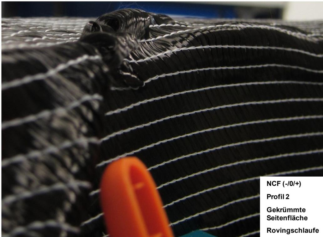
Abbildung 22: Während der Drapierung aufgetretene Rovingschlaufen an einer Falte (NCF (-/0/+))
