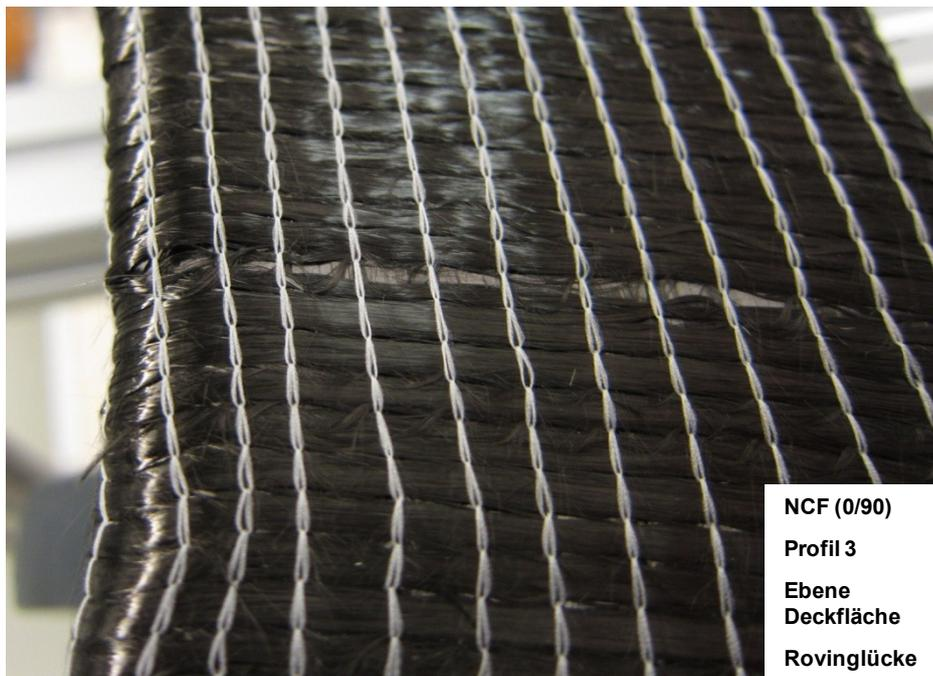
Abbildung 44: Rovinglücke und Rovingbeschädigung
