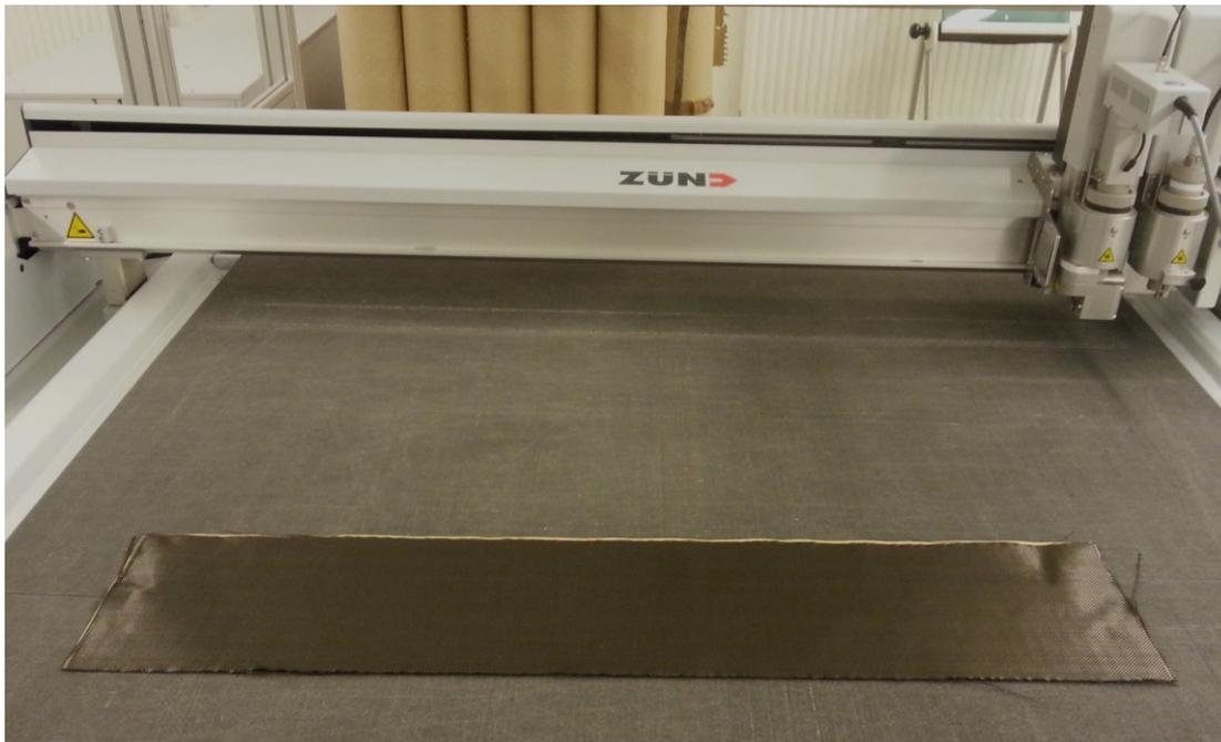
Abbildung 11: Mittels CNC-Cutter vorkonfektionierte CF Preform aus Leinwandgewebe
