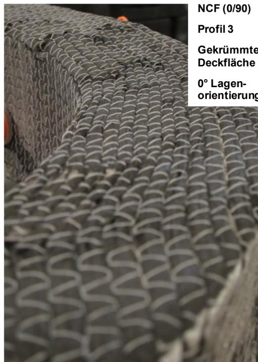
Abbildung 50: Verlust der Faserorientierung am Ende des Krümmungsbereichs
