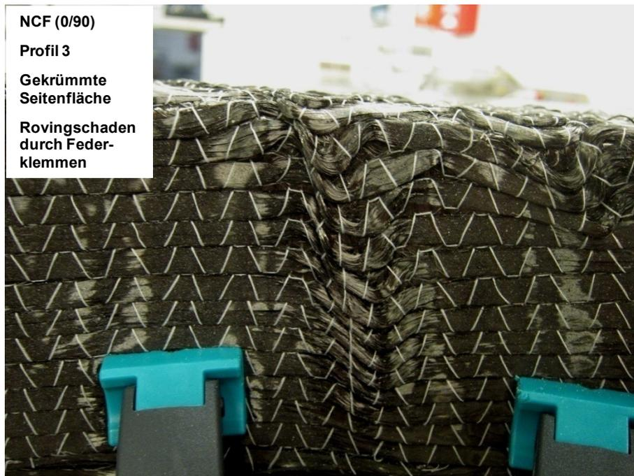
Abbildung 45: Rovingschädigung durch Klemmenbefestigung am NCF (0/90)
