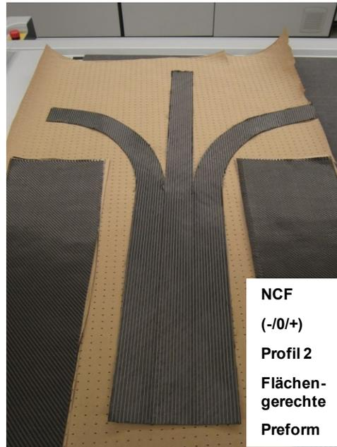
Abbildung 52: Flächengerechter Zuschnitt für das Profil 2 aus NCF (-/0/+)
