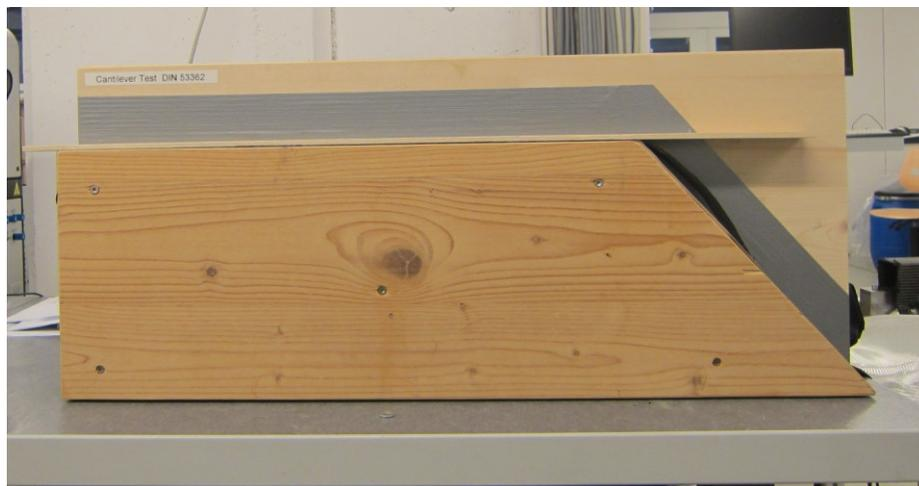
Abbildung 17: Versuchsprüfstand des Cantilever Tests
