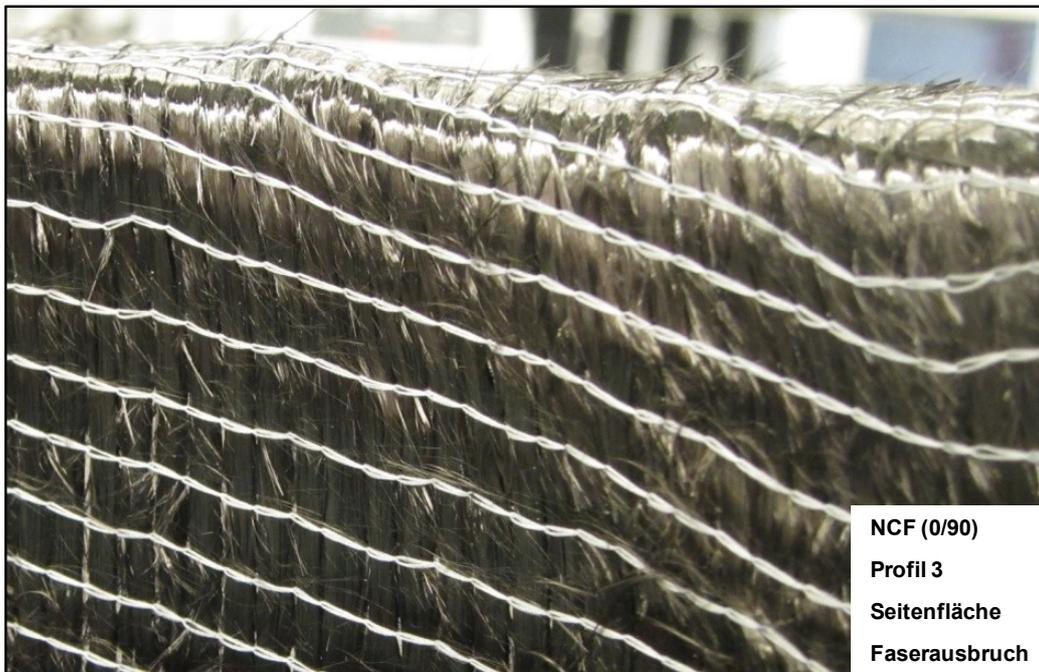
Abbildung 23: *Faserausbruch an einem NCF (0/90)*
