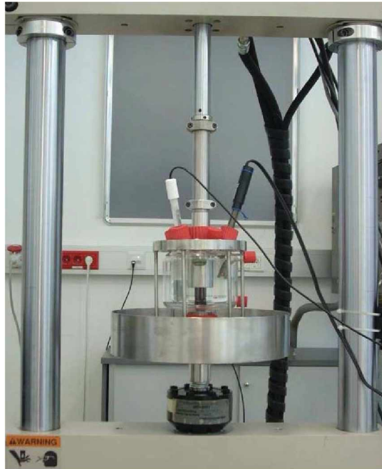
Abb. 4.39: Endgültiger Aufbau der Medienprüfzelle an der servo-hydraulischen Maschine mit Käfig, Auffangwanne und Messelektroden.
