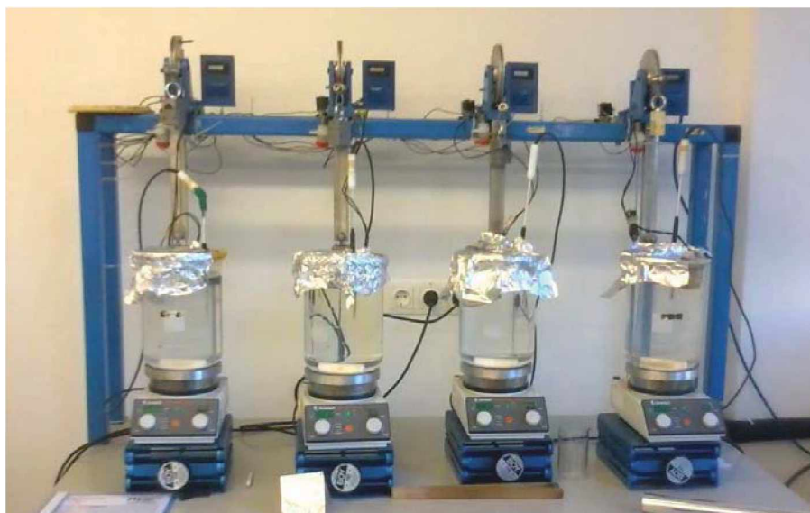
Abb. 3.4: Abgedichtete Glasbehältnisse der Arkopal®-Auslagerung bei 60°C.
