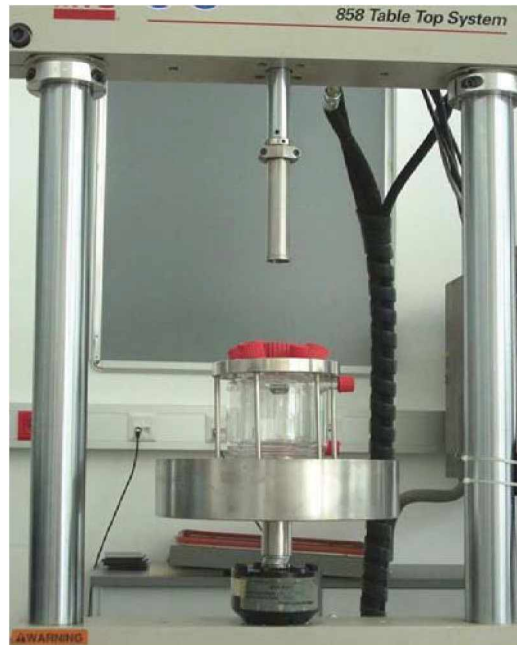
Abb. 4.36: Auffangwanne und Medienprüfzelle, stabilisiert durch den Käfig.
