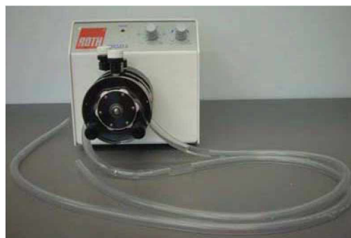
Abb. 4.37: Schlauchpumpe der Firma Roth (Karlsruhe, D) zum Befüllen und Entleeren der Medienprüfzellen.
