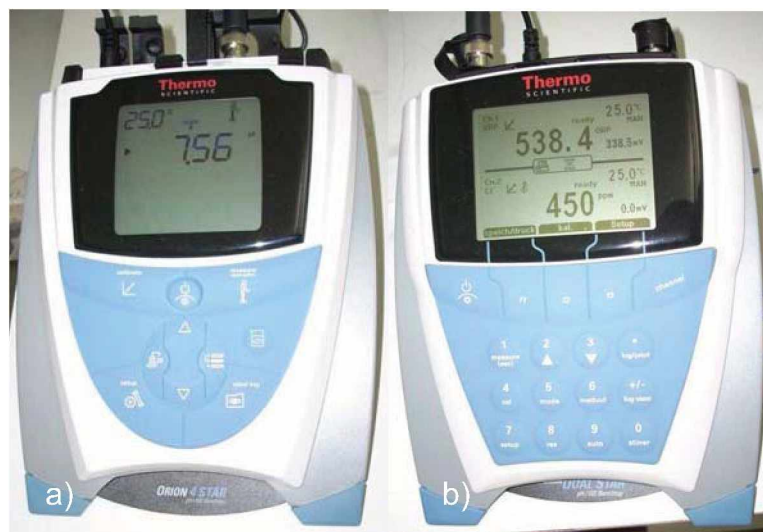
Abb. 4.41: Übersicht der beiden zur Verfügung stehenden Messgeräte. a) Orion 4-Star Meter; b) Orion Dual Star pH/ISE Meter (im Zwei-Kanal Modus).
