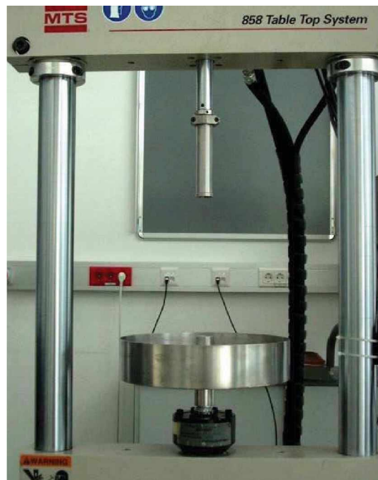
Abb. 4.35: Aufbau der unteren Einspannvorrichtung mit der aufgeschweißten Auffangwanne an der servo-hydraulischen Maschine.
