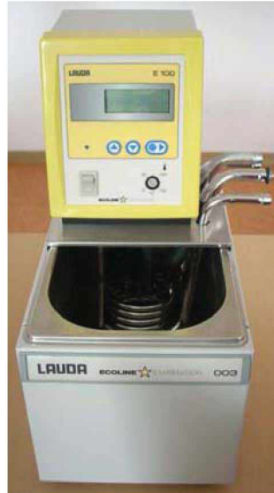
Abb. 4.38: Temperiereinheit für die Medienprüfzelle der Firma Lauda (Königshofen, D).
