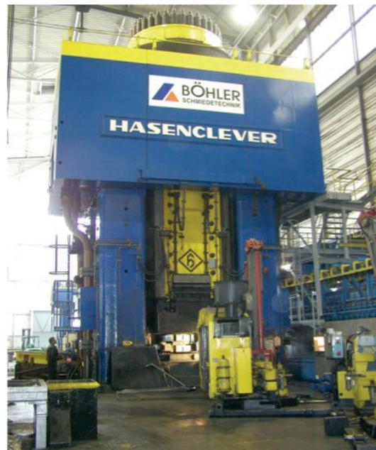
Abbildung 2: Spindelpresse SP31 mit 315 MN Presskraft
