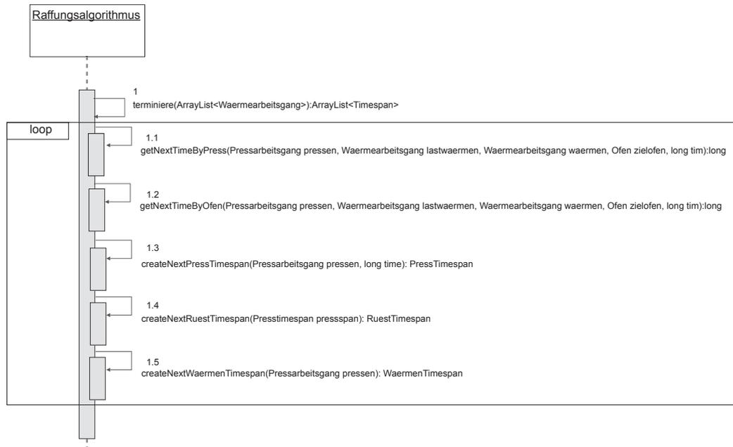
Abbildung 15: Überprüfungsalgorithmus Pressenproblem
