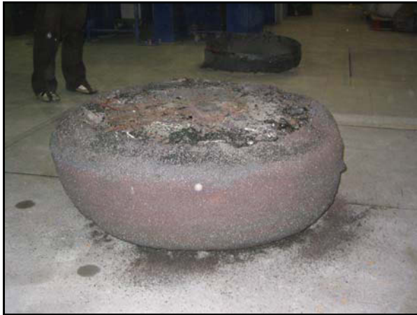
Abbildung 55: Schlacke-Metall-Block des Pilotversuches
