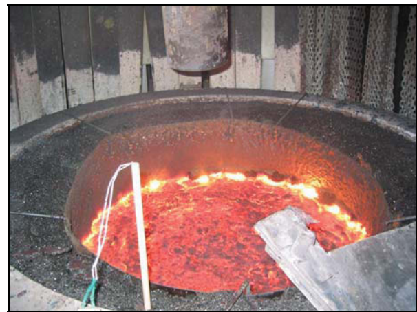
Abbildung 54: Zustand nach dem Abbrand (mit einer Temperatursonde in der Seitenwand)
