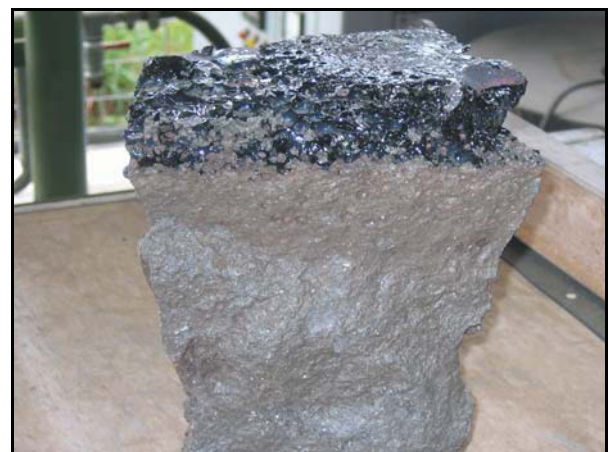
Abbildung 58: Darstellung der erstarrten Schlacke (Mitte)
