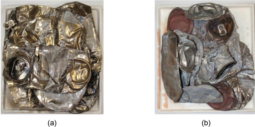
Abbildung 50: Dosen (a) bei 450 °C abgeschwelt (b) bei 550 °C abgeschwelt
