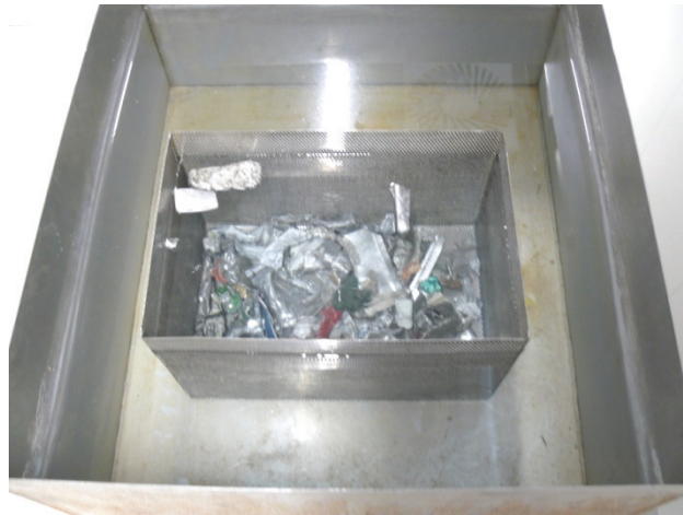
Abbildung 30: Probenbehälter im Wasserbad
