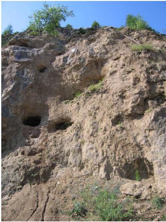
Abbildung 19: Tagbau Bürgl Etage 10; sehr mürber, erdig wirkender Magnesit mit Dolomiteinschaltungen.
