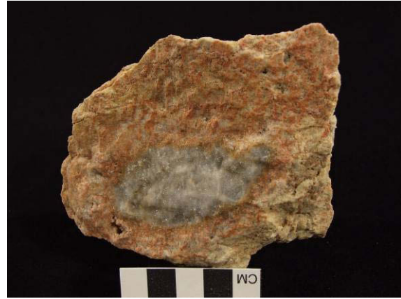
Abbildung 29: Abbaufeld 1 Sohle 1; orange-brauner Magnesit mit 5 cm großer, grauer Dolomitlinse.
