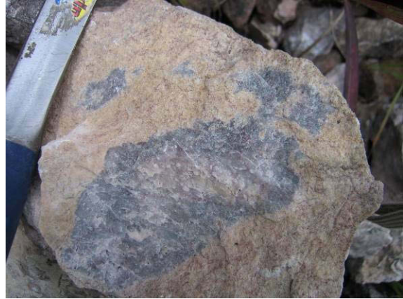
Abbildung 15: Rettenwand Etage 13; rötlich brauner Dolomit mit bis zu 15 cm großen, grau weißen Dolomitknollen als Einschlüsse.
