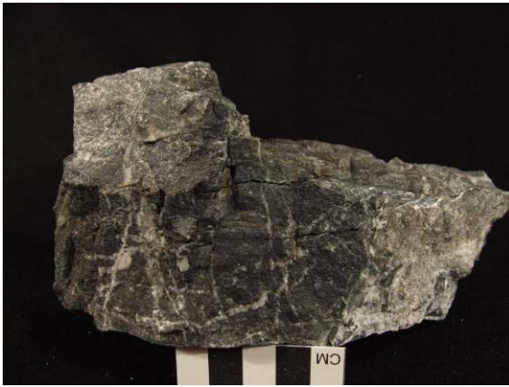
Abbildung 30: Abbaufeld 1 Sohle 1; schwarzer Magnesit mit weißen Dolomitadern.
