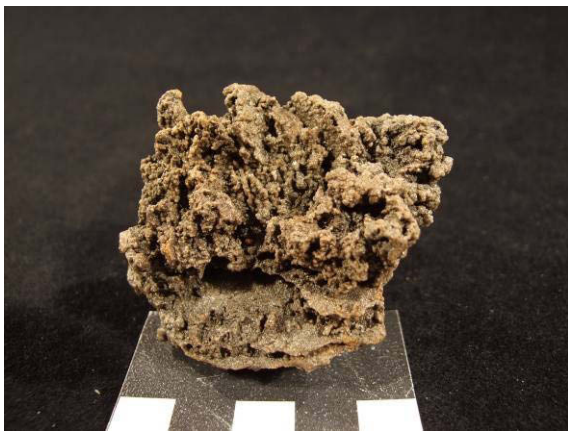
Abbildung 26: Abbaufeld 2 Sohle 1; dolomitische Konkretionen aus Karsthohlräumen des Magnesits, „Zellendolomit“.
