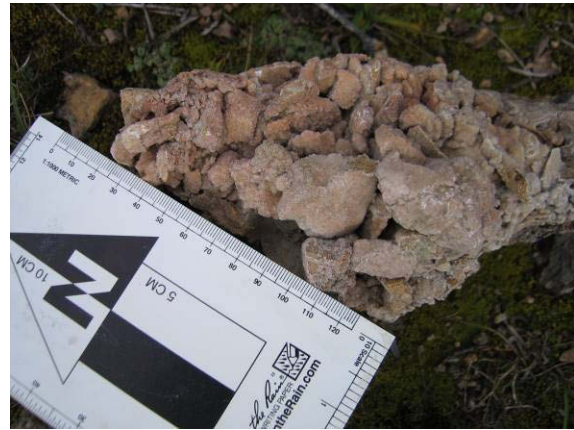
Abbildung 11: Rettenwand, nördlich der Seilbahnachse; Dolomitbreckzie mit kalzitischem Überzug.
