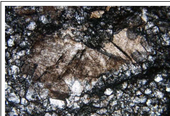
Abbildung 59: Probe C3: grobkörniger Dolomit (braun) wird von mittelkörnigem Dolomit verdrängt; N//; Bildbreite 4 mm.
