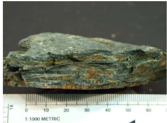
Abbildung 24: Bürgl Tagbau Etage 0; Porphyroidschiefer mit dünnen Quarzlagen und braunen Kluftbelägen.
