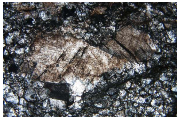
Abbildung 60: Probe C3: grobkörniger Dolomit (braun) wird von mittelkörnigem Dolomit verdrängt; N+; Bildbreite 4 mm.
