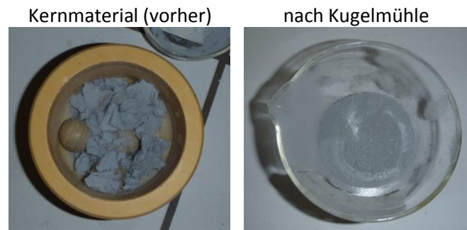
Abbildung 60: Unbehandelte und gemahlene MG4
