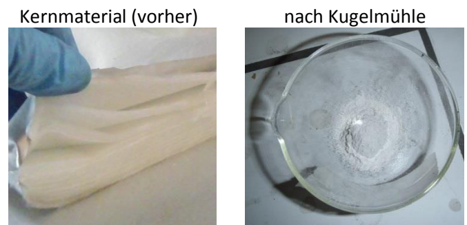
Abbildung 50: Unbehandelte und gemahlene MG2
