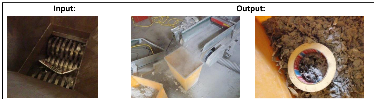
Abbildung 37: Input und Output des Materials „graues Pulver“ (MG4)
