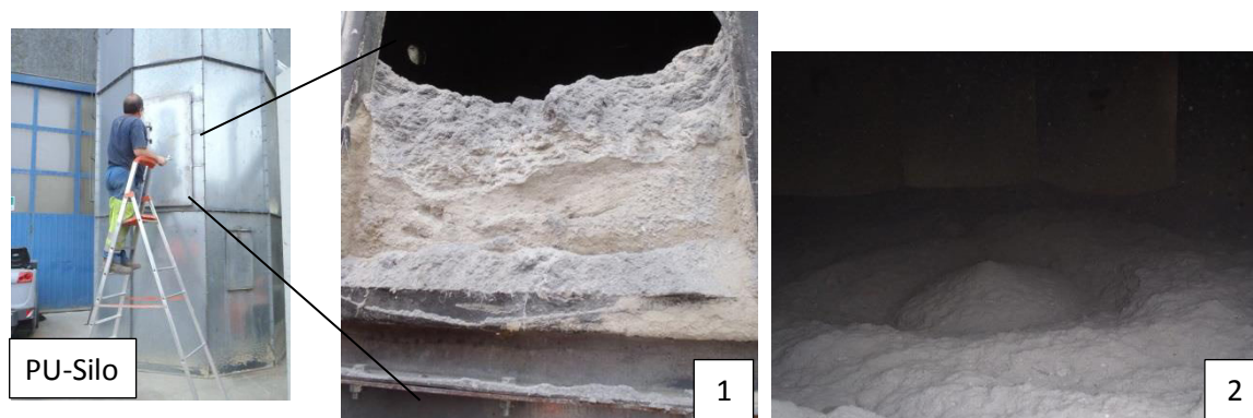
Abbildung 103: PU-Fraktion gemischt mit VIP-Materialien (1: Schichtprofil, 2: Inneres des PU-Silos)
