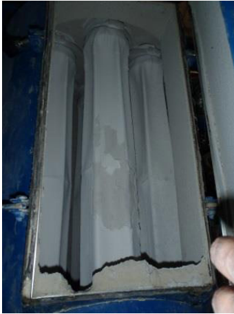
Abbildung 80: Anhaftungen am Papierfilter
