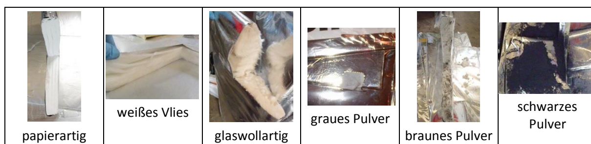
Abbildung 9: Unterschiedliche Materialgruppen von Vakuumisulationspaneelen
