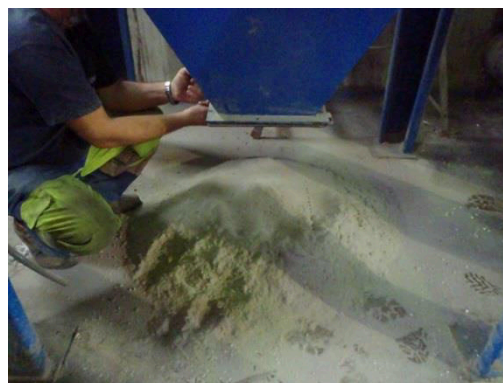
Abbildung 102: Beladung des Filters direkt nach dem Zerkleinerer
