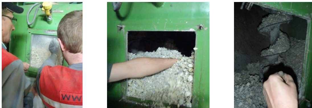
Abbildung 75: Öffnen der Klappe zum Schneckenaustrag (3 Bilder)
