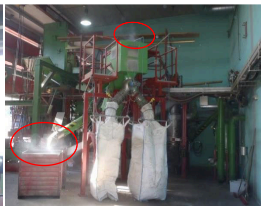
Abbildung 79: Staubentwicklung in der Halle der Output-Materialien
