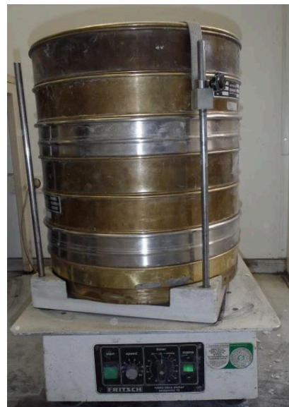
Abbildung 40: Siebturm auf Schüttler
