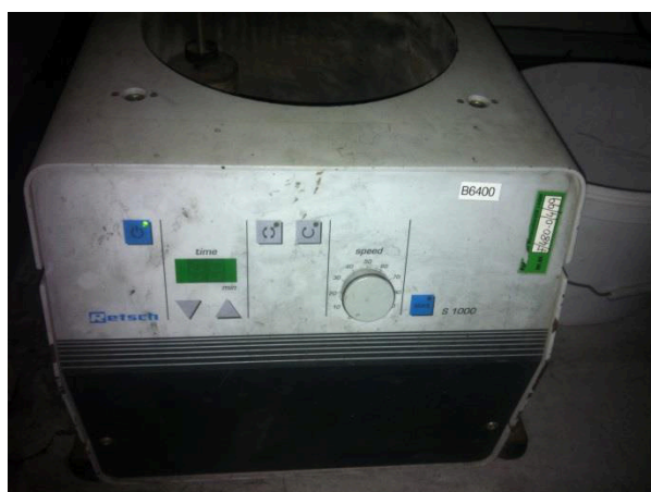
Abbildung 41: Verwendete Kugelmühle der Firma Retsch (Modell S 1000)
