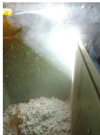
Abbildung 34: Staubentwicklung von MG2
