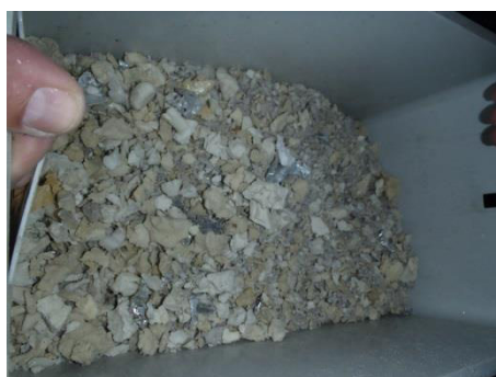
Abbildung 76: PU-Fraktion vermischt mit VIP-Material
