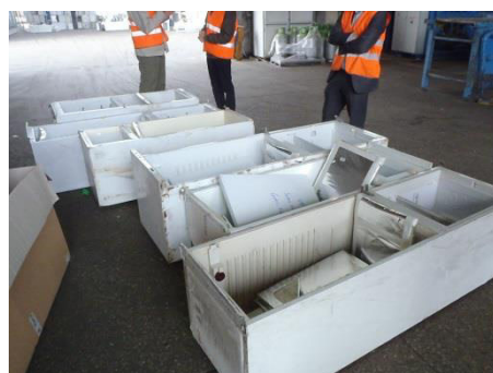
Abbildung 96: Befüllte Geräte mit MG3-Paneeelen (Angiari)
