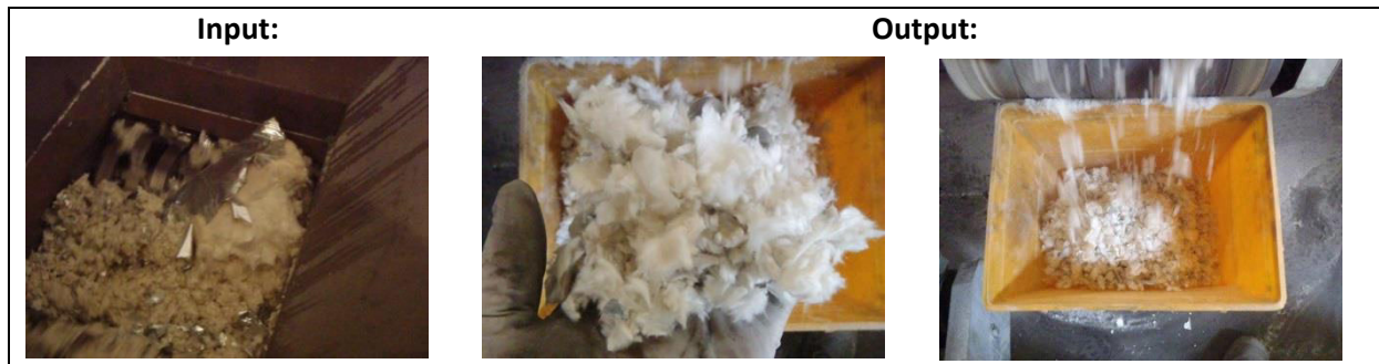
Abbildung 36: Input und Output des Materials „glaswollartig“ (MG3)
