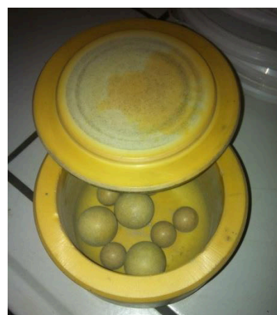
Abbildung 41: Verwendete Kugelmühle der Firma Retsch (Modell S 1000)
