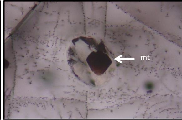
Abb. 143: Einschluss mit idiomorphem Magnetit, Bildbreite 0,1mm.
