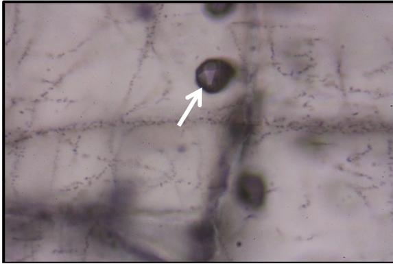
Abb. 142: Leerer Einschluss mit negativer Kristallform ohne Fluid oder fester Phase, Bildbreite 0,1mm.
