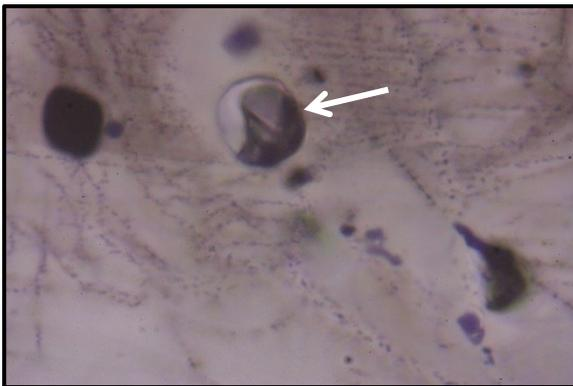
Abb. 138: Einschluss mit großem Karbonatkristall im Forsterit, Bildbreite 0,1mm.
