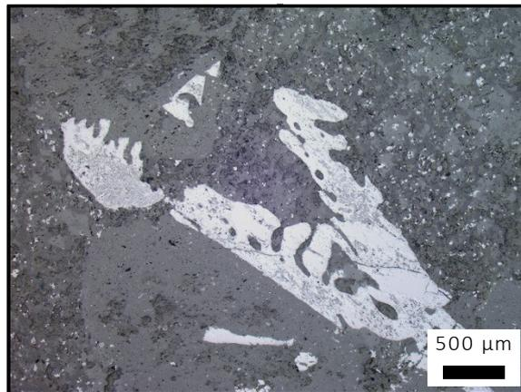
Abb. 137: Skelettförmiger Magnetit unter
