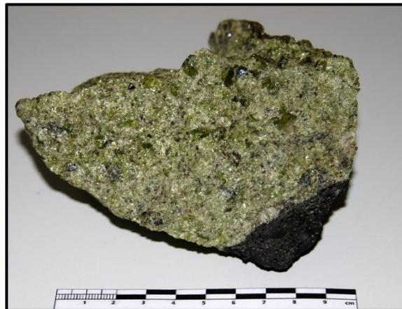
Abb. 88: Peridotitischer Xenolith LZ1.
