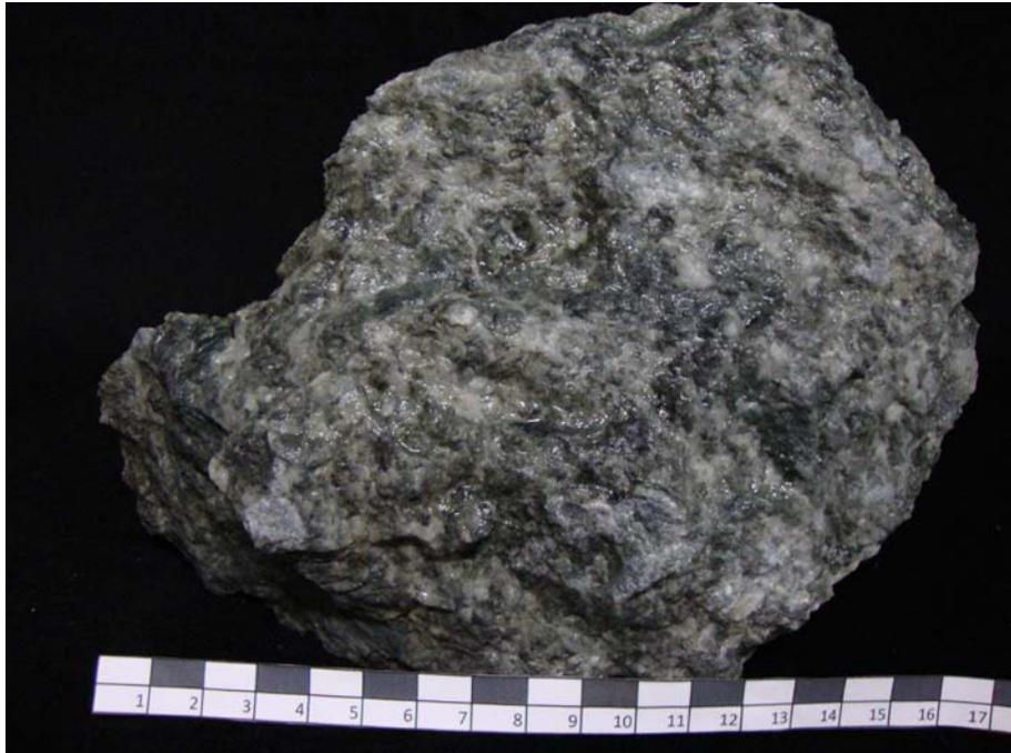
**Abbildung 24:** Handstück eines muscovitreichen Quarzphyllites mit gut erkennbaren Quarz-Feldspat-Bereichen (Probe G19); Maßstab in cm.
