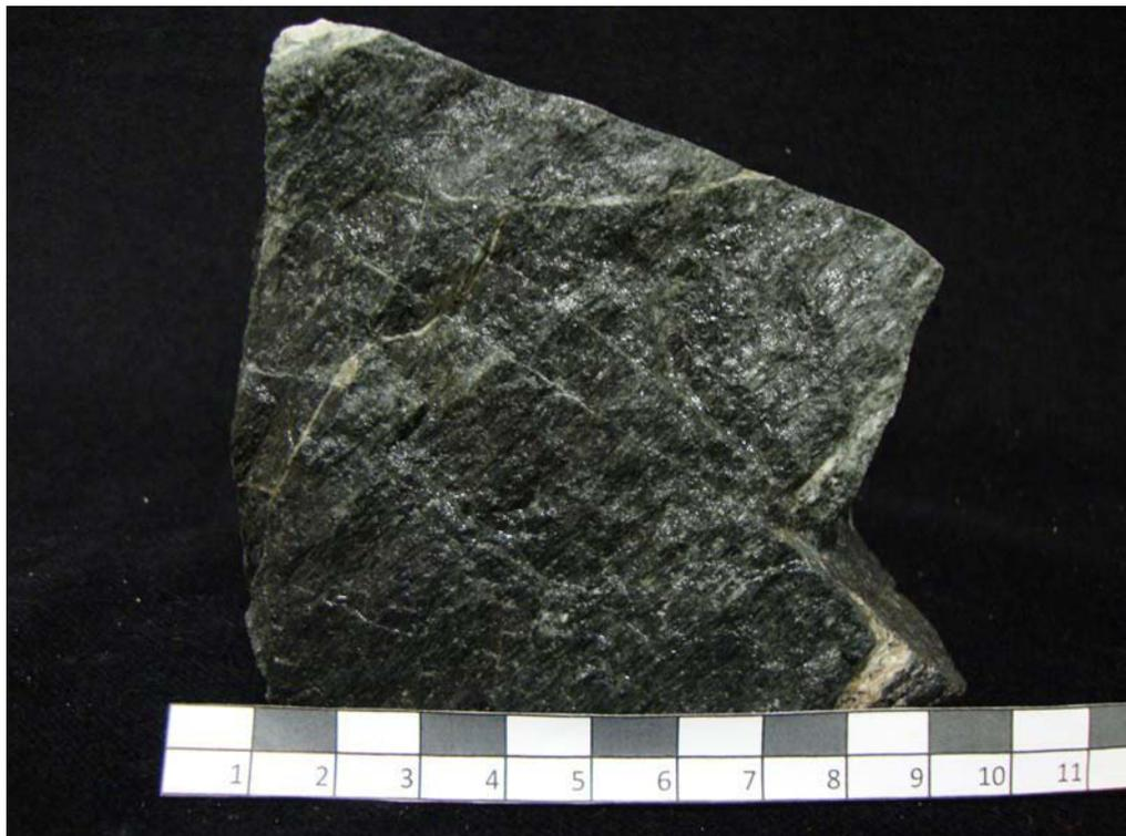
**Abbildung 27:** Handstück eines massigen Amphibolits mit hellen Quarz-Feldspat-Gängchen (Probe G31/1); Maßstab in cm.
