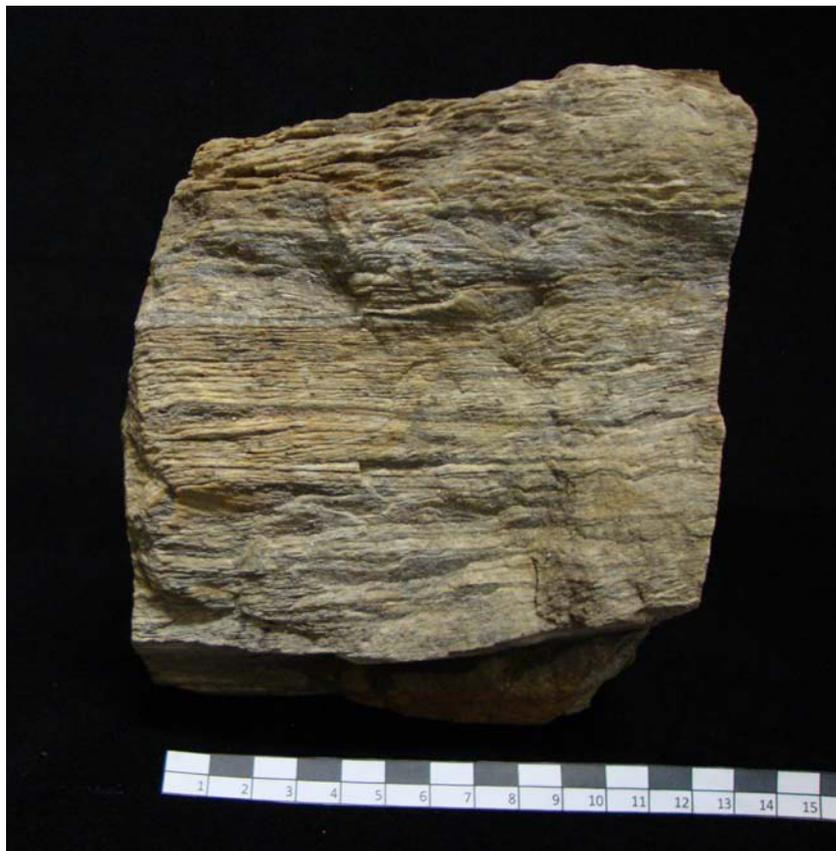
**Abbildung 28:** Handstück eines Porphyroids mit deutlich sichtbarer hell-dunkel Bänderung parallel zur Schieferung (Probe G26/1); Maßstab in cm.
